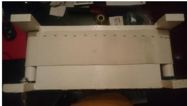
**Figura 3.14** Banda transportadora con soportes para reforzar y soportar el peso.
