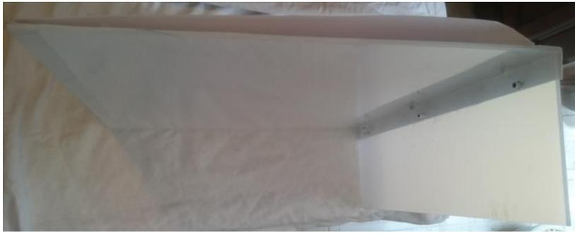
**Figura 3.15** Piezas de acrílico montadas en el ángulo de aluminio
