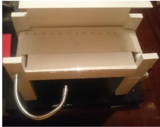
*Figura 3.17 Soporte de metal sujetado a la banda transportadora*
