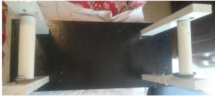
**Figura 3.9** Rodillos ensamblados a los soportes verticales mediante los orificios de 0.635cm
