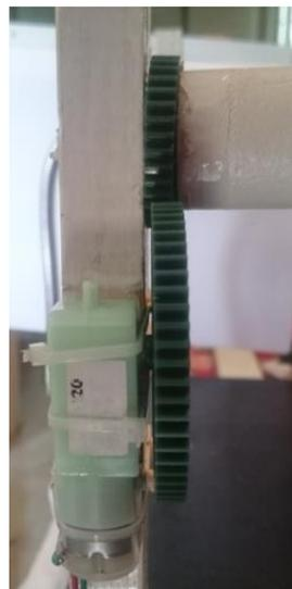
**Figura 3.10** Motorreductor sujeto al soporte vertical con los engranes en sincronía para girar
