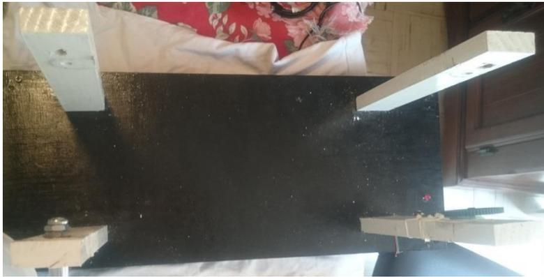
*Figura 3.7 Montaje de los 4 soportes verticales a la base de madera plana*
