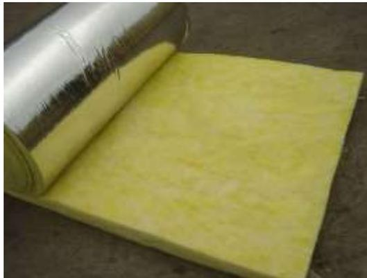
**Fig. 1.6. Material absorbente a base de lana de vidrio**
