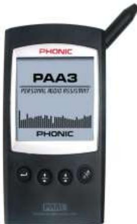
**Fig. 2.3. Analizador de audio portátil PHONIC PAA3**
