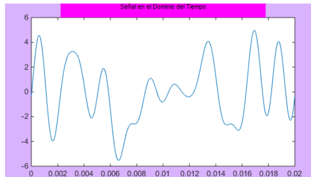
Figura 4.22 Símbolo OFDM obtenido del generador.
