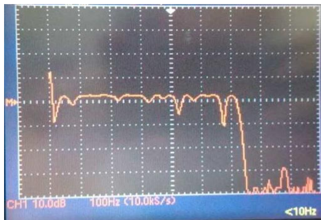
Figura 4.31 Espectro del símbolo F-OFDM en el osciloscopio.
