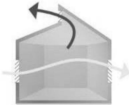
Figura1. 11. Sistema de ventilación natural.
