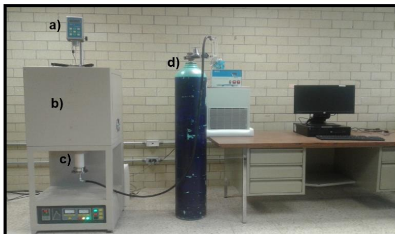
Figura 15 Esquema general del equipo experimental. a) Viscosímetro tipo rotacional; b) Horno vertical; c) Tubo de alta alúmina; d) Gas Argón
