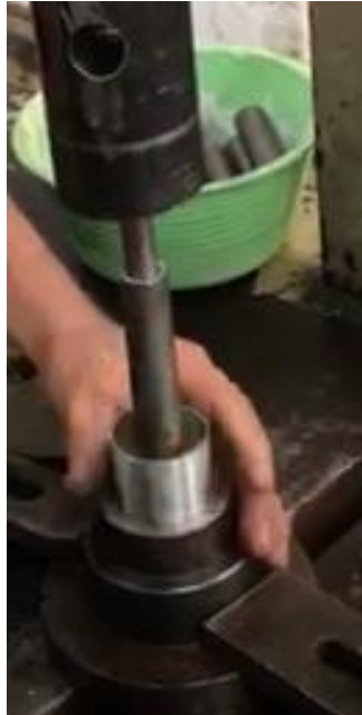
Figura 36. Colocación de molde y eje (elaboración propia)
