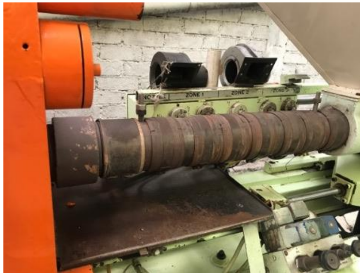
Figura 27. Fundición materia prima (elaboración propia)
