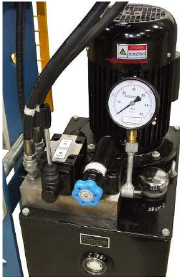
Figura 49. Unidad de potencia
