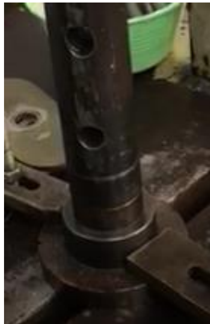
Figura 37. Prensado de la pieza e inserción del eje (elaboración propia)
