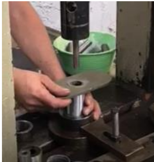
Figura 33. Colocación de molde, pieza y placa limitadora (elaboración propia)
