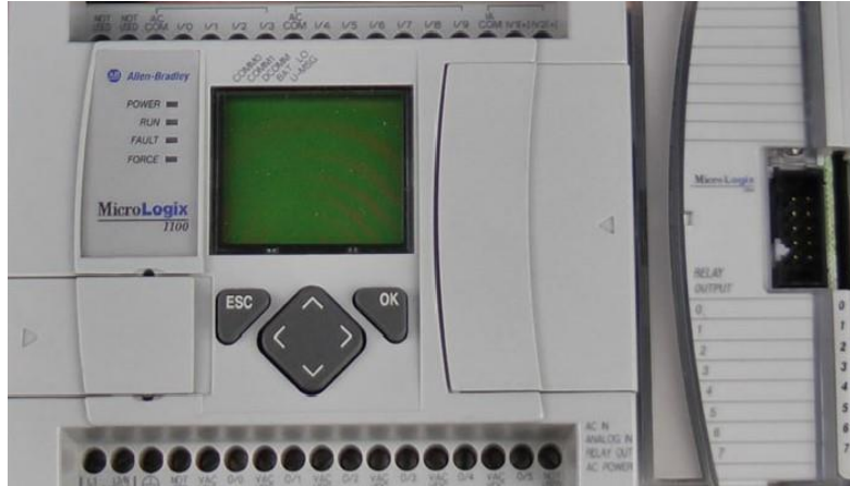
Figura 55. Micrologix 1100 con módulo de D/I (elaboración propia)
