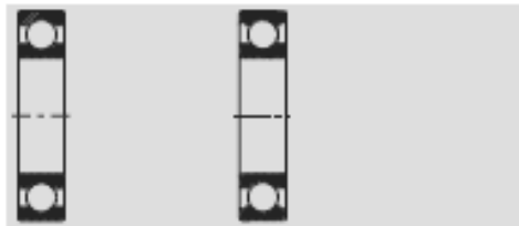
Rodamiento rígido de bolas abierto sin acanaladuras Rodamiento rígido de bolas abierto acanalado en el aro exterior (ejemplo)
