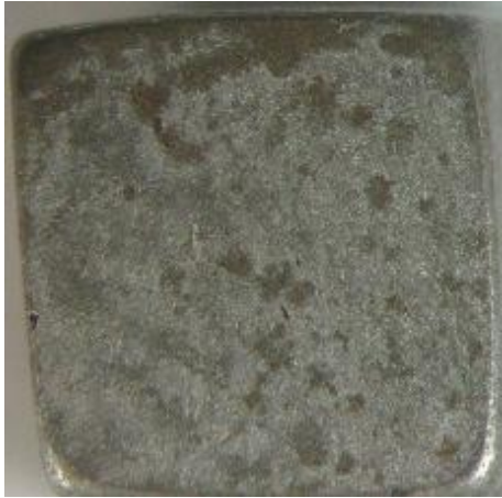
Fig. 21. Efecto de la corrosión en muestra de grano fino
