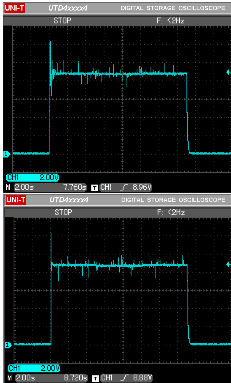
Figura 4.15: Resultados experimentales: evolución temporal del voltaje de salida v(t) con el esquema EGCE y del esquema propuesto en el osciloscopio, respectivamente.
