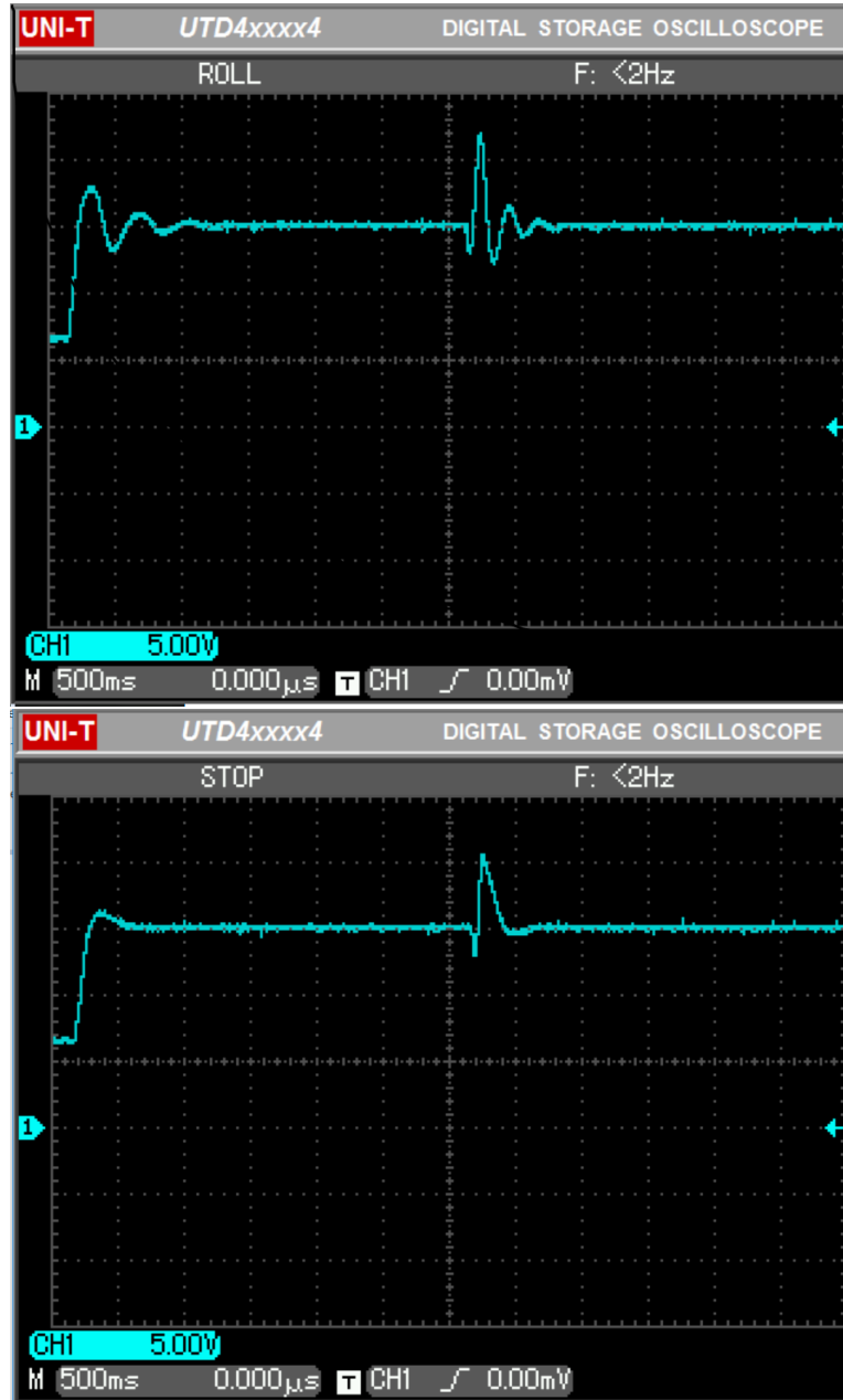
Figura 3.5: Resultados experimentales: respuesta del voltaje de salida v_o(t) del controlador KAO (3.35) y del controlador propuesto (3.41)–(3.42) graficados en el osciloscopio, respectivamente.
