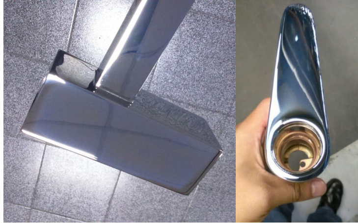
Figura 29: Ambas imágenes muestran material con defecto de mancha blanca. (García 2018).
