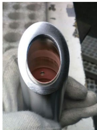
Figura 24: Se observa material con contaminación metálica por zinc (García 2015).
