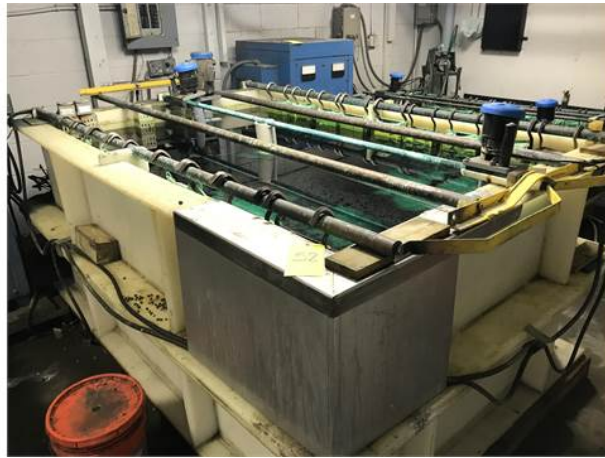
Figura 8: Tina electrolítica de recubrimiento de níquel. (BidSpotter: 2019).
