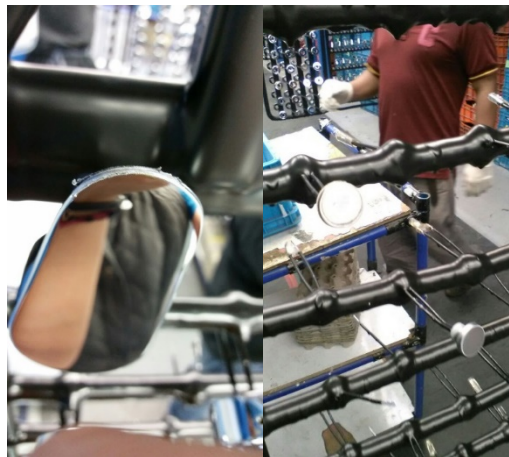
Figura 30: Material afectado con sobre deposición de material originando arborescencias en las aristas del material. (García 2017).
