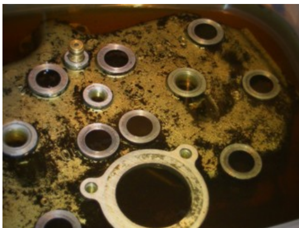
Figura 5: Piezas en proceso de decapado para la remoción de óxidos (Recubrimientos metálicos Vicente S L.: 2019).
