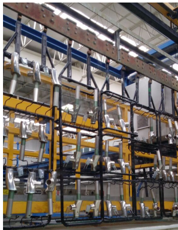
Figura 19: Material con acabado níquel semi-brillante (la apariencia blancuzca mejor conocida como aperlado es característica de estos depósitos). (García 2015).
