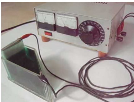
Figura 39: Conexión de la celda para obtener el depósito de níquel brillante. (Zamora: 2019).
