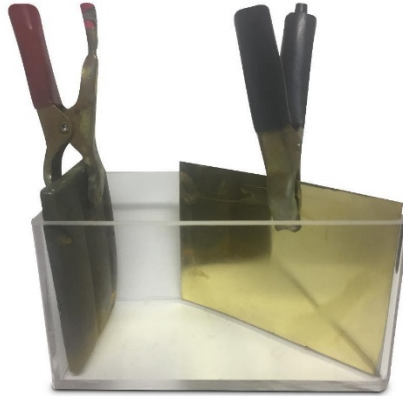
Figura. 40: Posición de los electrodos. Ánodo a la izquierda y cátodo a la derecha. (Zamora: 2019).
