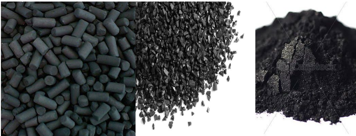
Figura 22: Diferentes presentaciones de carbón activado. Pellets (lado izquierdo), granular (centro) y polvo (lado derecho). (canstock: 2019).
