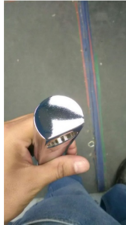
Figura 27: Material afectado por picado. (García 2016).
