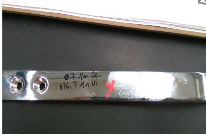
Figura 25: Material con bajo espesor los espesores que presenta este recubrimiento no cumplen con los estándares de calidad marcados por la empresa. (García 2017).
