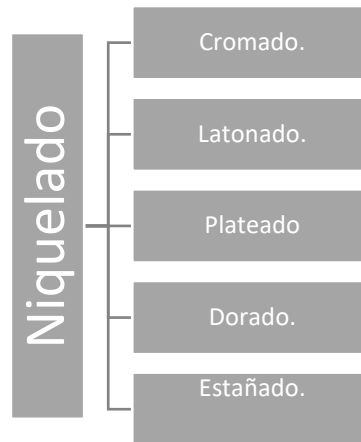
Figura 7: Esquema que muestra en qué tipo de recubrimiento metálico es usado como subcapa en tratamientos electrolíticos. (Ambioma consult, SL: 2007, Guía sobre las mejores técnicas disponibles en España del sector de tratamiento de superficies metálicas y plásticas, 322).
