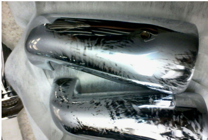
Figura 26: Material con mala adherencia se aprecia que el material no presenta un recubrimiento homogéneo. (García 2017).
