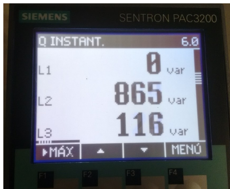
Figura 3.55. Medición de la potencia reactiva.
