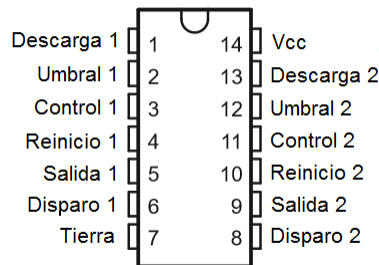
Fig. 2-16 Terminales del circuito integrado NE556
