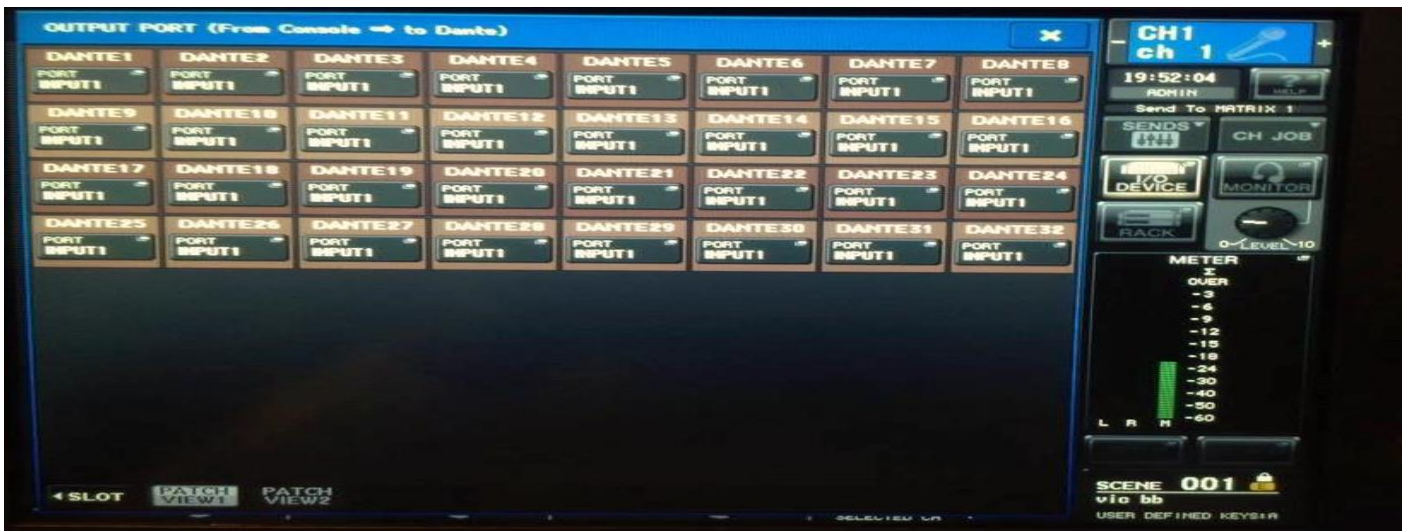
Figura 3.30 Mezcladora QL1 de Yamaha, asignación de INPUT 1 a los 32 canales Dante para ser distribuidos en la red (Software Dante Patch).
