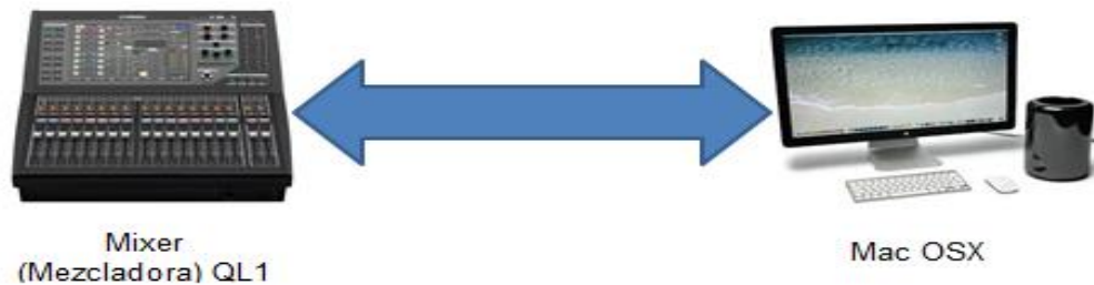
Figura 2.6 Configuración Unicast (conexión punto a punto).
