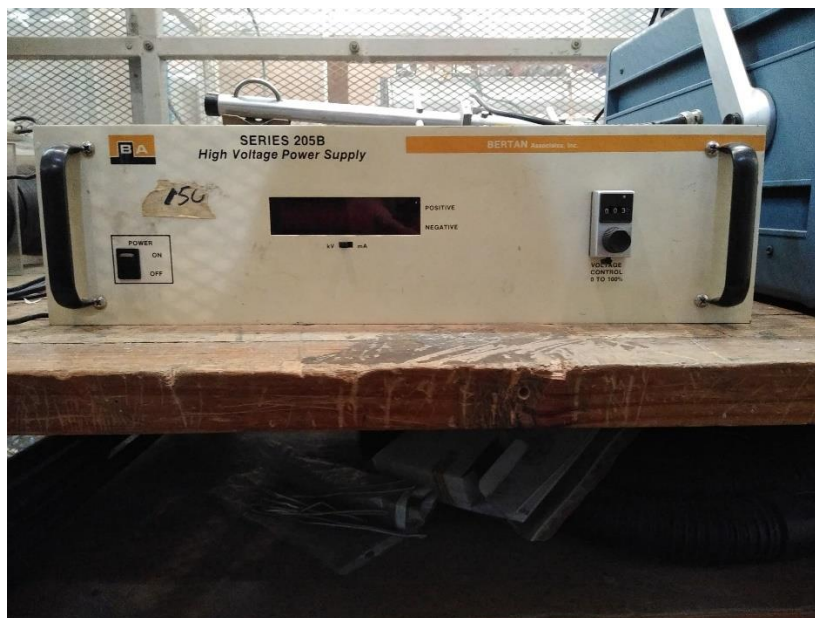
Figura 4. 4 Fuente de Alto Voltaje de Corriente Directa
