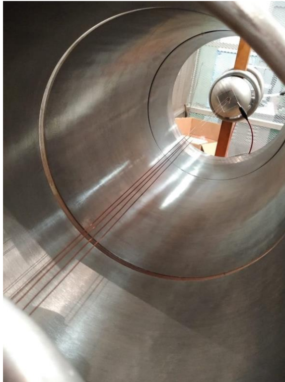
Figura 4.9 Arreglo en haz de 4 conductores
