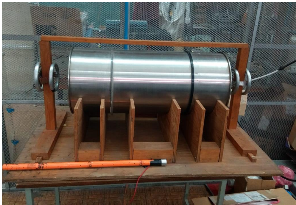
Figura 4.1 Jaula corona del laboratorio de alta tensión de ESIME Zacatenco.
