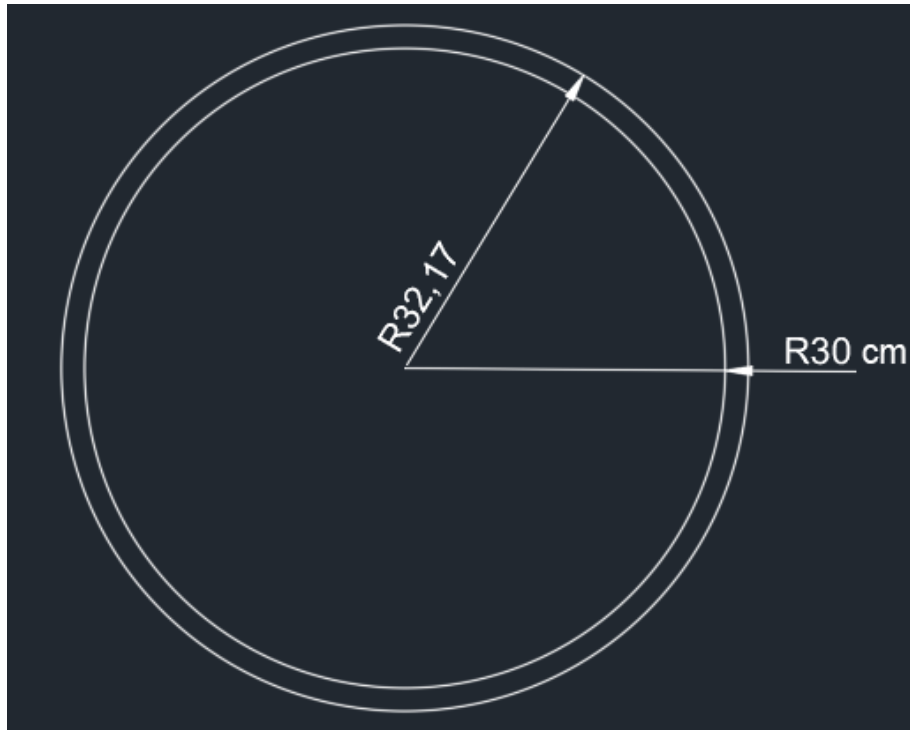
Figura 4.12 Vista frontal del rolado propuesto.
