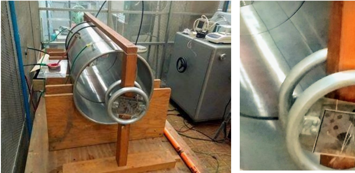
Figura 4.8 Arreglo de dos conductores.
