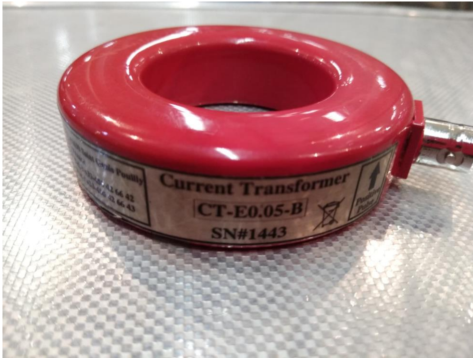
Figura 4. 5 Transformador de Corriente
