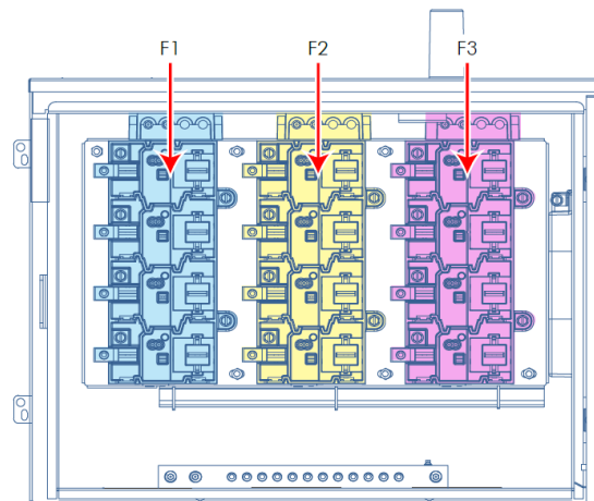
Figura 3.14. Gabinete de medidores EOS GMM12T y medidor tipo gabinete PROTECSA MCR-3G.
