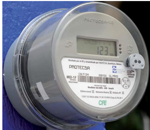
Figura 1.13. Medidor inteligente de CFE. Gómez López, J., M., et al. (2015). Aplicación de tecnologías de medición avanzada (AMI) como instrumento para reducción de pérdidas. Boletín IIE, p. 181.
