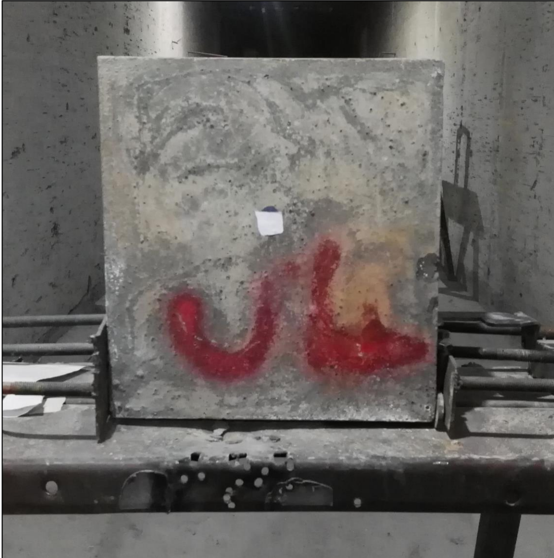
Fig.45. Probeta CBHME 01 de 40x40x15 cm de dimensión, sin recubrimiento polimérico, previo impacto de arma de fuego. Imagen cortesía de la Fábrica de Cartuchos del Ejército Mexicano, Campo Militar No. 1-F, Santa Fe, Cd. Méx.
