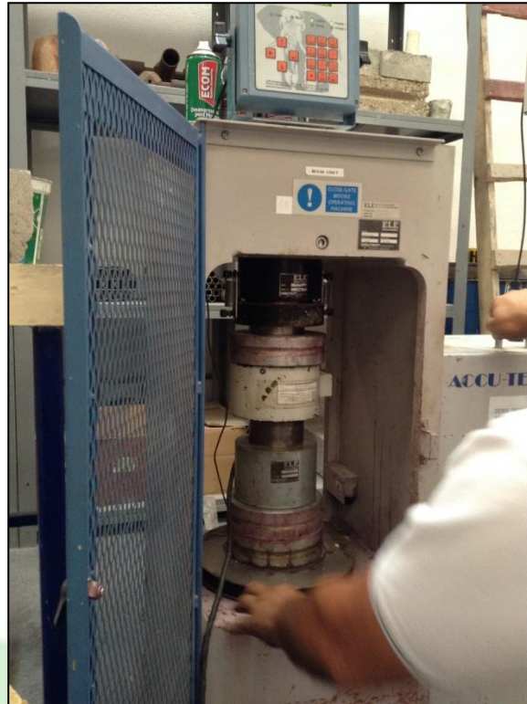
Fig. 39. Empleo de una celda de carga para calibración de la máquina de compresión ELE serie CT-7540A.
