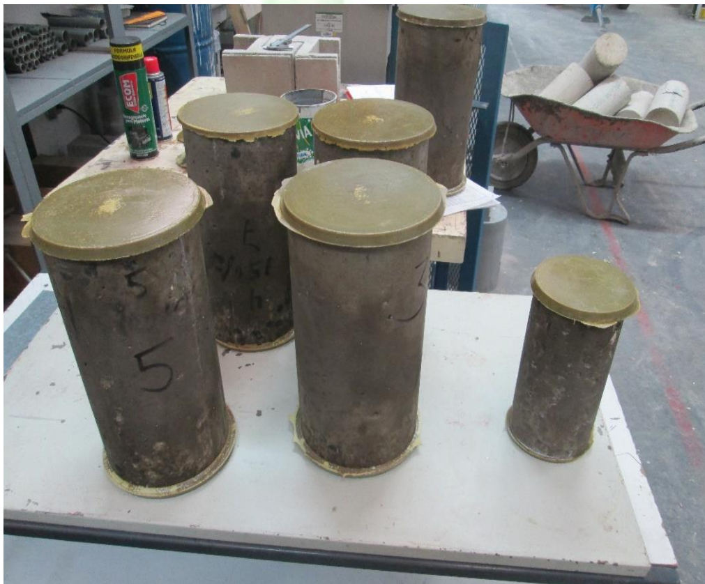
Fig. 38. Cilindros de concreto CPC Ultrafino listos para ensayos de resistencia a la compresión.
