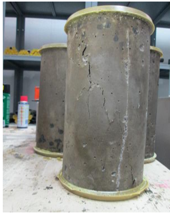
Fig. 42 Plano de falla de un espécimen de concreto.
