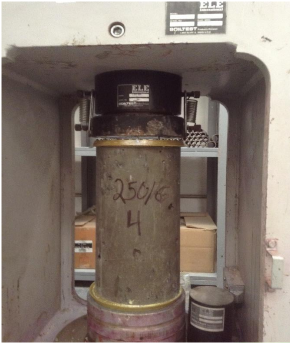
Fig. 41. Especimen listo para ser fallado.
