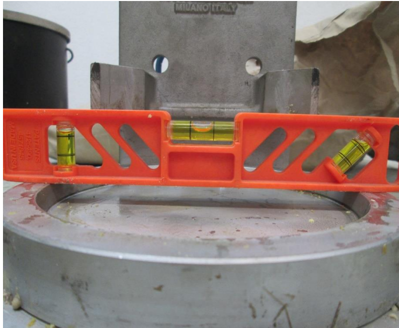
Fig. 34. Plato metálico nivelado para el cabeceo de especímenes cilíndricos con mortero de azufre.
