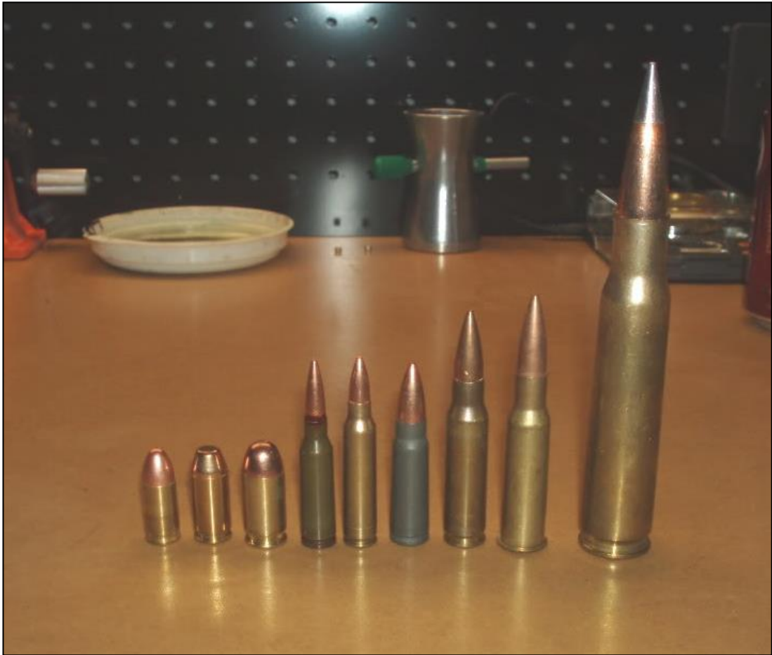
Fig. 13. Fotografía que muestra la variedad de calibres usados por las fuerzas armadas alrededor del mundo, de izquierda a derecha: calibre 9 mm, 9 mm expansivo, .45, 5.56, 7.62 x 39 mm, .308 Winchester, 7.62 x 51 mm y 12.7 x 99 mm. [Imagen cortesía de la Fábrica de Cartuchos del Ejército Mexicano, Campo Mil. No. 1-F Santa Fe, Cd. Méx. 2016]
