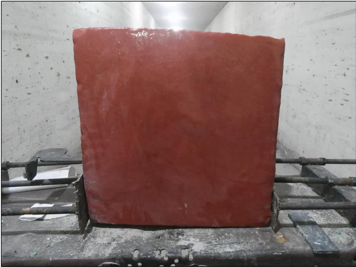
Fig.47. Probeta CBPHME 01 de 40x40x15 cm de dimensión, con recubrimiento polimérico, previo impacto de arma de fuego. Imagen cortesía de la Fábrica de Cartuchos del Ejército Mexicano, Campo Militar No. 1-F, Santa Fe, Cd. Méx.
