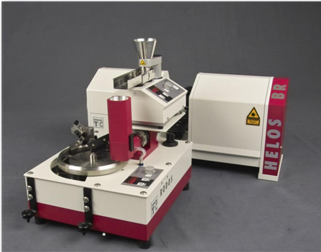
Fig. 16. Equipo Sympatec's Laser Diffraction, Sensor HELOS. Utilizado para la obtención de Distribución de Tamaño de Partícula en polvos.
