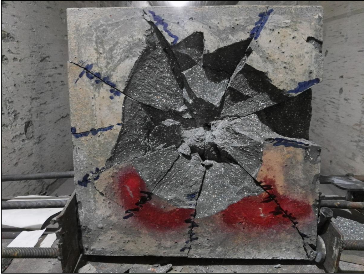
Fig.46. Probeta CBHME 01 de 40x40x15 cm sin recubrimiento polimérico, posterior a impacto de Barret Cal. 50. Imagen cortesía de la Fábrica de Cartuchos del Ejército Mexicano, (Campo Mil. No. 1-F, Santa Fe, Cd. México).
