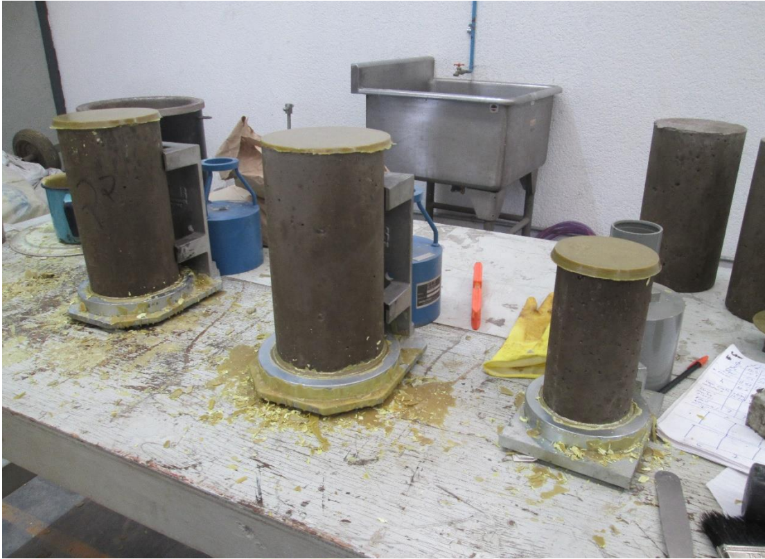
Fig. 35. Cabeceo con mortero de azufre de cilindros de concreto.
