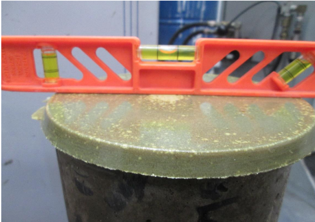
Fig. 36. Cabeceo nivelado de un cilindro de concreto.
