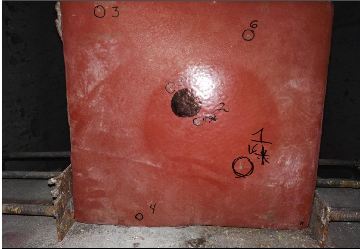
Fig.48. Probeta CBPHME 01 de 40x40x15 cm con recubrimiento polimérico, posterior a 6 (SEIS) impactos de Barret Cal. 50. Imagen cortesía de la Fabrica de Cartuchos del Ejército Mexicano, (Campo Mil. No. 1-F, Santa Fe, Cd. México).
