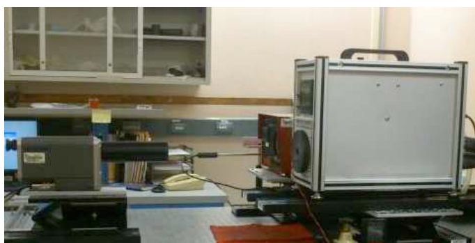
Figura 33. Alineación del termómetro de radiación.
