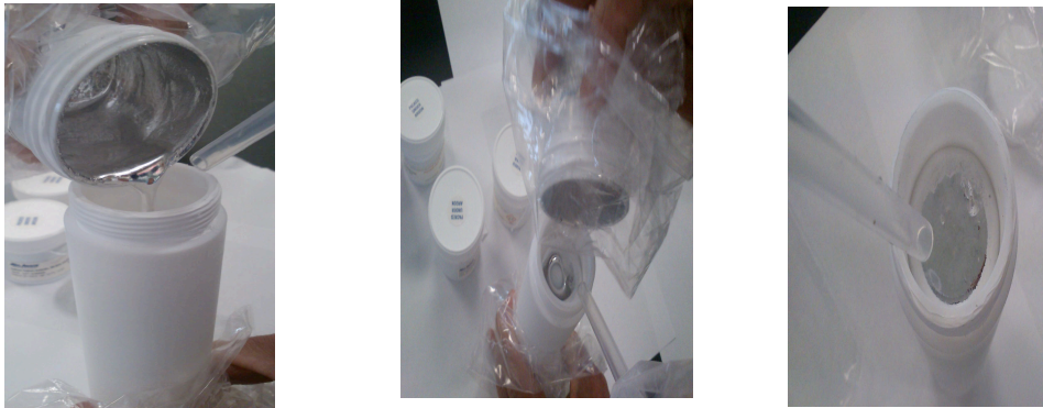
Figura 24. Llenado del crisol con el eutéctico Ga-In.
