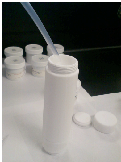
Figura 23. Argón inyectado dentro del crisol para desplazar el aire contenido.
