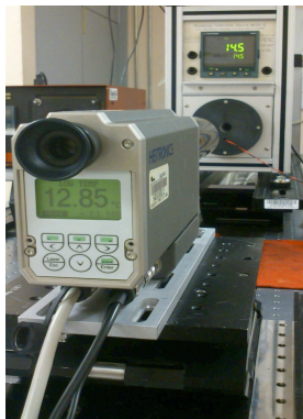
Figura 35. Mediciones de temperatura de radiancia de la transición de fase del eutéctico Ga-In con el termómetro de radiación.
