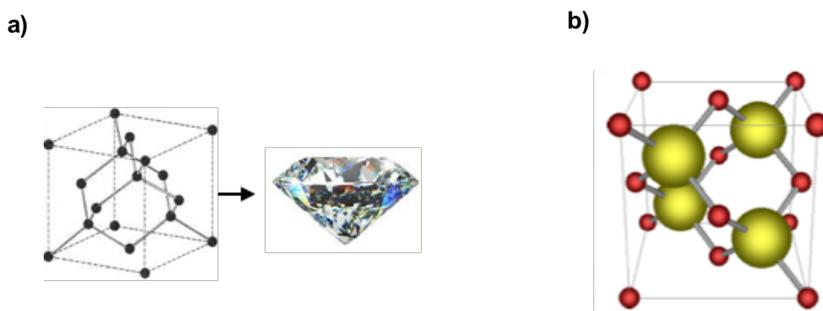
Figura 1.14. Esquema comparativo de la estructura *fcc* para: a) el diamante, las esferas negras representan átomos de carbono. b) ZB de CdS, las esferas rojas representan átomos de S y las amarillas átomos de Cd.
