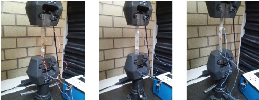
Figura 6.3. Ensayo de tensión para probetas de policarbonato solo y policarbonato reforzado.
