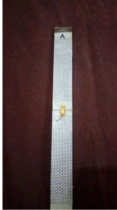
Figura 6.2. Probeta con galga para obtención de deformaciones.
