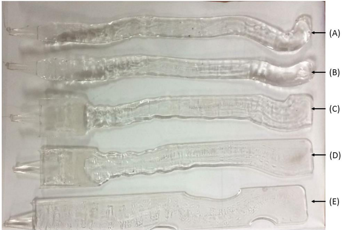
Figura 5.3: Pruebas de inyección. (A) Máximo volumen de inyección. (B) Compactación 2 t. (C) Compactación 4 t. (D) Compactación 6t. (E) Compactación 8t.
