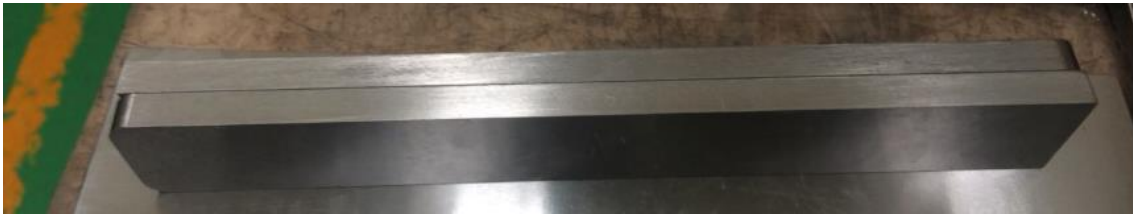
Figura 4.8: Corazón del lado móvil, Acero 4140 T, ajuste h6.
