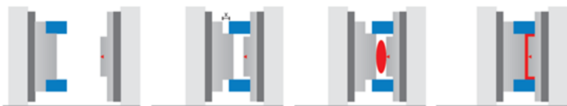
Figura 3.2. Proceso de moldeo por inyección-compresión.
