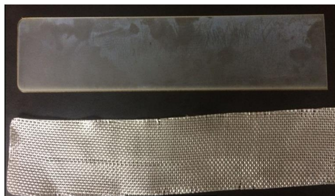
Figura 5.8: Inserto de película de policarbonato y fibra de vidrio.
