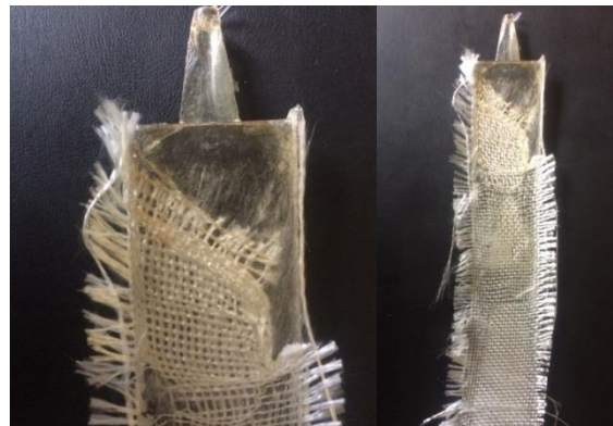
Figura 5.5: Degradación por inyección y desorientación de la fibra.
