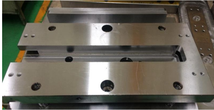
Figura 4.7: Cavity lado fijo, concluida.
