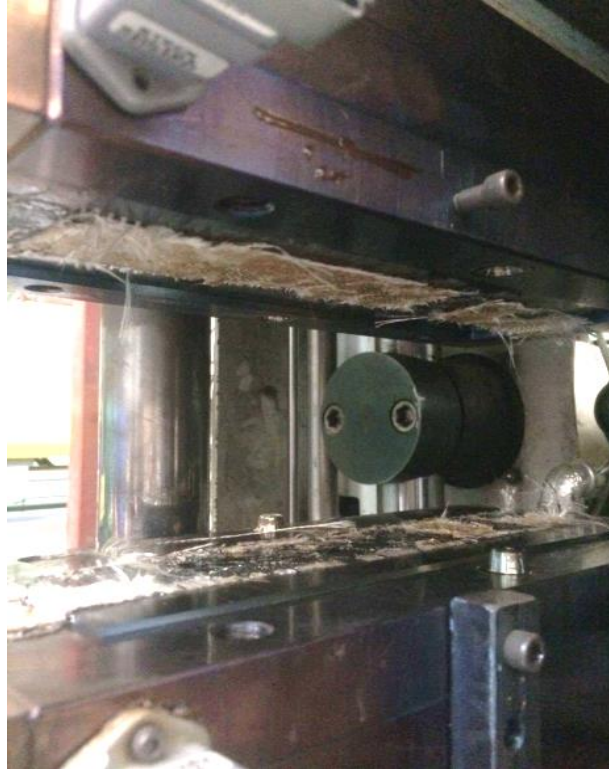
Figura 5.2: Herramental abierto durante el proceso de compresión.
