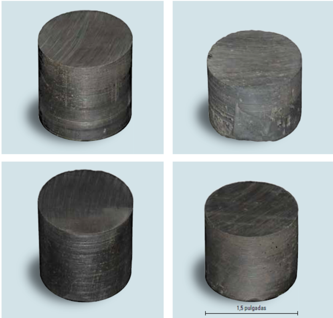
Figura 2.4 Núcleos de lutita extraídos durante operaciones rotativas (Fotografía: Larissa Walker, Agarwal et al, 2013).
