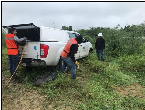
Fotografía 4.7. Uso del vehículo Pick-Up para sostener el polín con el eje trasero. (Sitio 2: Cd. Victoria)
