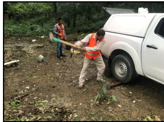
Fotografía 4.8. Generación de impactos al polín, para posteriormente golpear el lado contrario (Sitio 1: Tamazunchale).
