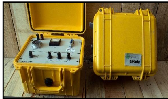
Fotografía 4.5 Controlador en superficie, Marca Geostuff
