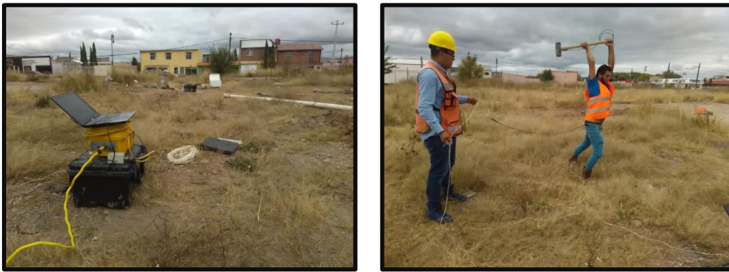
Fotografía 4.1 Equipo de exploración geosísmica utilizada en los puntos de medición de MASW.
