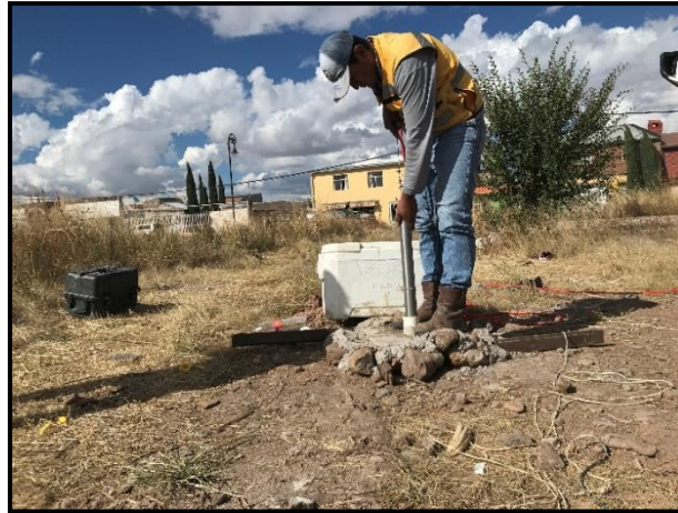
Fotografía 4.6. Geófono de pozo modelo SSBH, Marca SARA. (Utilizado en Cd. Guerrero).
