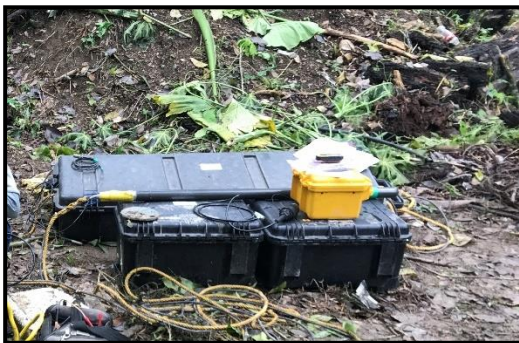
Fotografía 4.4 Geófono de pozo modelo BHG-3, de la Marca Geostuff
