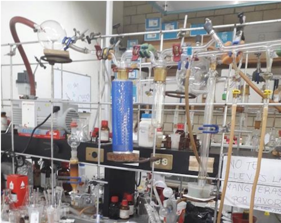
Fig. 2.2 Montaje para el sellado a vacío de las ampolletas para la síntesis de materiales tipo MOF.
