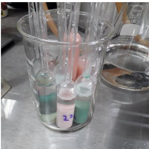
Fig. 2.1 Ampollitas con las mezclas en la preparación de materiales Co-MOF.
