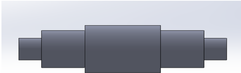
Figura 3.6. Rodillo con reducción de diámetros para el acoplamiento de chumaceras.
