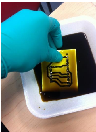
Figura 4.19. Eliminación del cobre con cloruro férrico.
