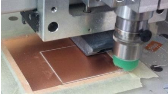
Figura 4.23. Maquinado de la PCB del motor a pasos
