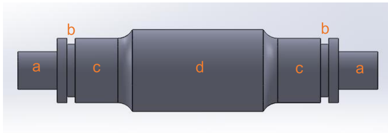
Figura 3.7. Rodillo con concentradores de esfuerzos (a) Piñón, (b) Tensor, (c) Chumacera (d) Laminación.
