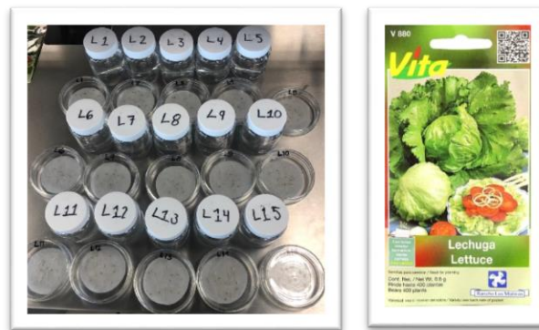
Ilustración 17. Ensayo de toxicidad de aguas lixiviadas
