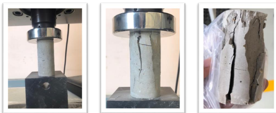
Ilustración 20. Ensayo de resistencia a la compresión de especímenes
