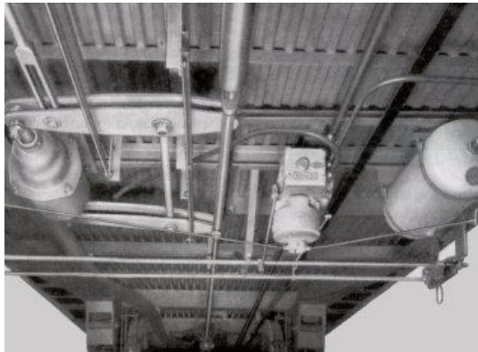
Fig.1.12 Sistema de freno automático por aire comprimido.
