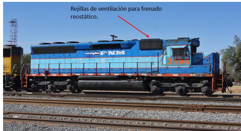
Fig. 1.17 Rejillas de ventilación para frenado reostático que muestra la ubicación de las resistencias de potencia en un ferrocarril.
