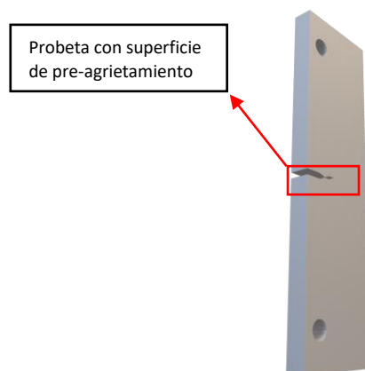
Fig. 15. Ensamble entre el modelo de probeta ESE (T) y la superficie de pre-agrietamiento.
