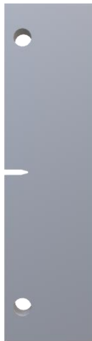
Fig. 11. Modelo de simulación de probeta ESE (T).
