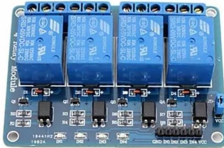
Figura 3.21 Relevador de 4 canales opto acoplados [23]
