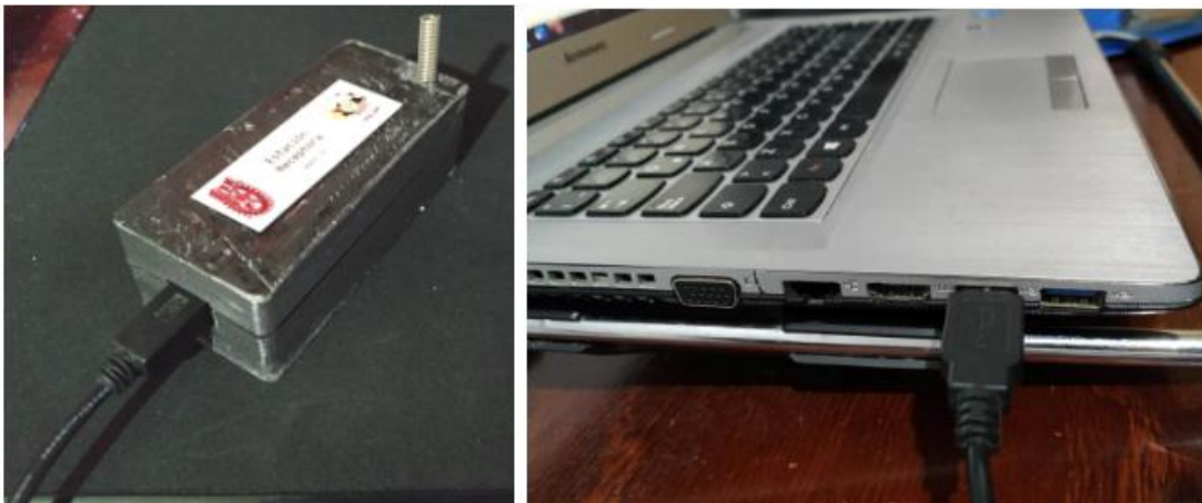
Imagen 2.3.- Conexión de la estación receptora al ordenador mediante el cable USB.
