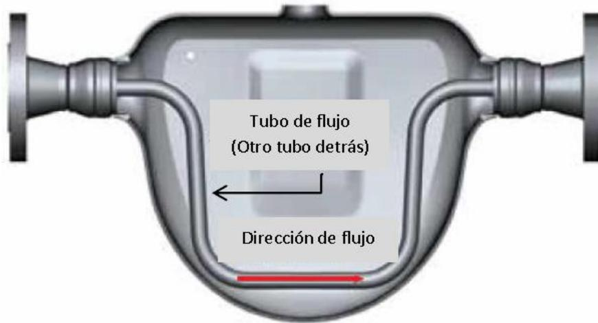
Figura 88. Medidor Coriolis Básico ("Tom O' Banion", 2013)
