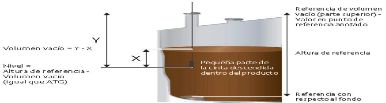
**Figura 43. Definiciones de la Medición Manual de Volumen Vacío en líquidos pesados como petróleo negro petróleo crudo (Emerson, 2017, "Guía de Medición en Tanques de Almacenamiento")**
