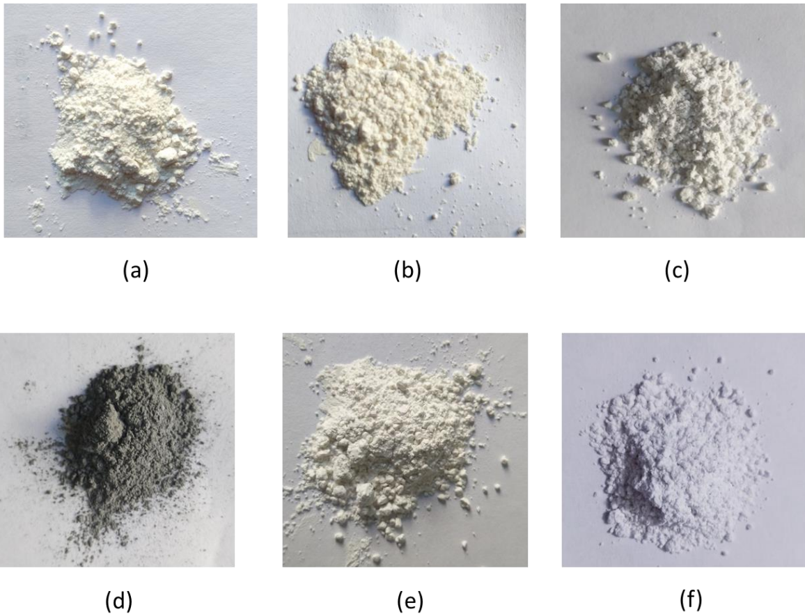
Figura 2.12 Principales componentes de los barnices. (a) Frita PF-200 (b) Esmalte PR-500 (c) Feldespato (d) Oxido de Cobalto , (e) Oxido de Zinc y (f) Oxido de Titanio
