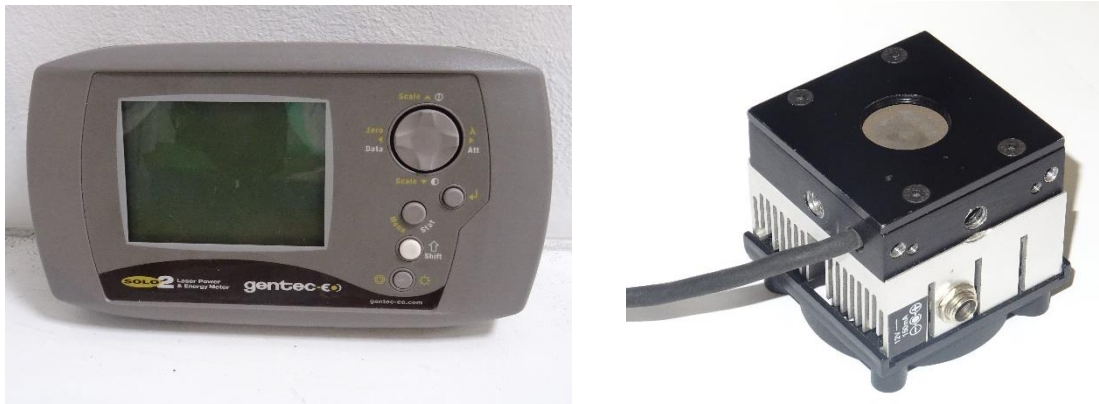
Figura 3.5 Medidor de Energía de haz láser, (izq.) Indicador de Potencia y (der.) Sensor de radiación
