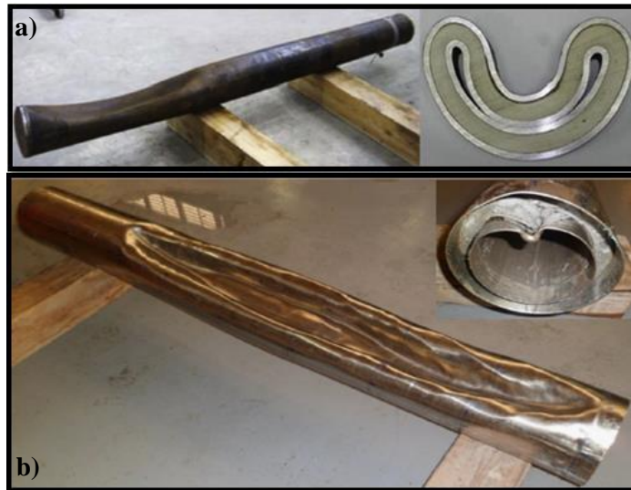
Figura I.16.- Pruebas experimentales de colapso en ducto compuesto a) con polipropileno (Castello and Estefen, 2007), b) compuestos de cemento reforzados con fibra de PVA (Chen et al., 2013)
