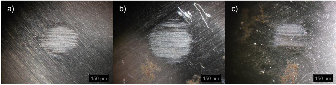
Fig. 79) Huellas de desgaste a la carga de prueba de 63 Kgf. a) Bola 1 b) Bola 2 c) Bola 3
