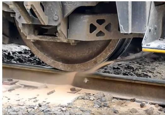
Fig. 11) Dispositivo a bordo surtidor de arena en contacto rueda-riel.
