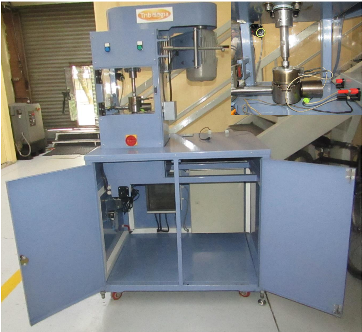
Fig. 25 Máquina de cuatro bolas del grupo de Tribología de la SEPI ESIME Zacatenco.
