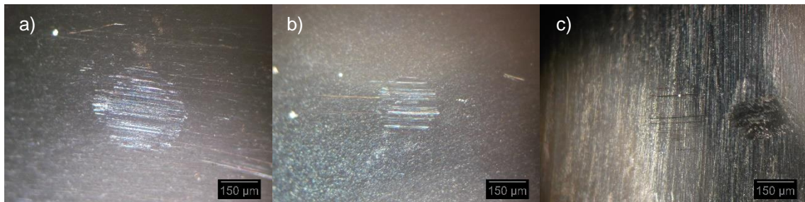
Fig. 90) Huellas de desgaste a la carga de prueba de 24 Kg. a) Bola 1 b) Bola 2 c) Bola 3
