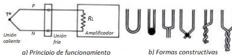
Fig. 36) Termopares y formas constructivas.
