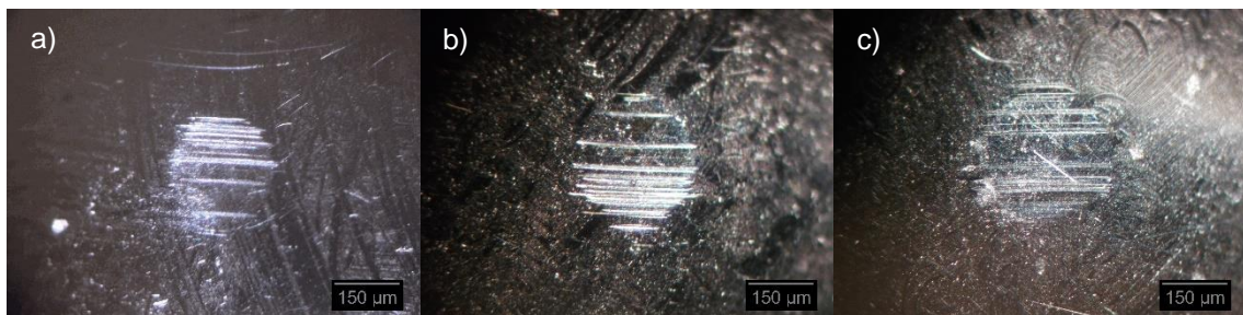
Fig. 77) Huellas de desgaste a la carga de prueba de 40 Kg f. a) Bola 1 b) Bola 2 c) Bola 3
