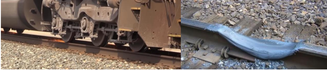
Fig. 10) Daño en contacto rueda-riel por baja fricción.
