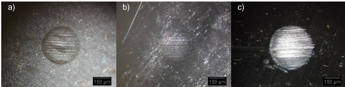
Fig. 95) Huellas de desgaste a la carga de prueba de 80 Kgf. a) Bola 1 b) Bola 2 c) Bola 3
