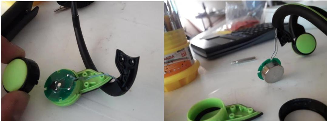
Figura 2.3.1. Transductor electromecánico. Se observa que las terminales de la bobina se encuentran sobre la placa, mientras que el imán que genera el campo magnético fijo tiene libertad de movimiento y es el que genera la vibración.
