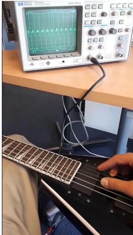
Figura 2.1.9. Medición de la señal producida por una guitarra eléctrica.
