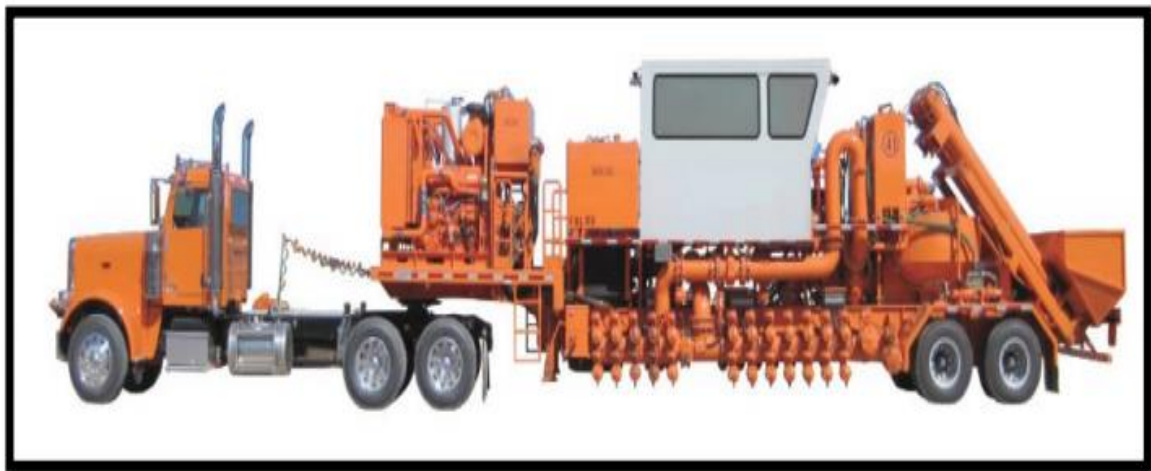
Figura 16.- Mezclador de productos químicos y apuntalante (blender).
