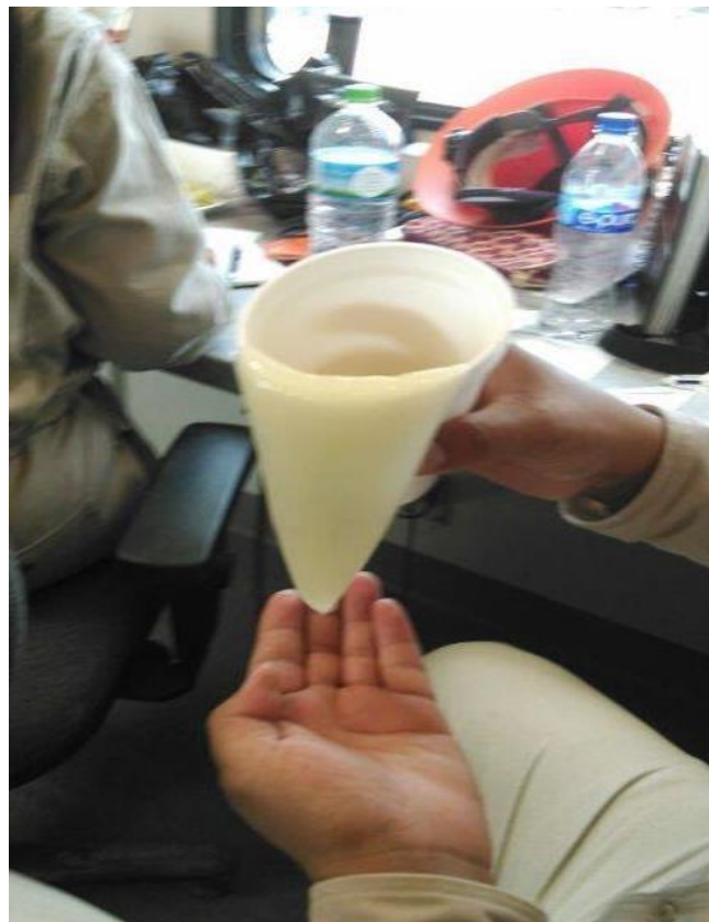
Figura 28.- Gel de fractura activado con el que se realizó la prueba de Minifrac en el pozo Jun 1.
