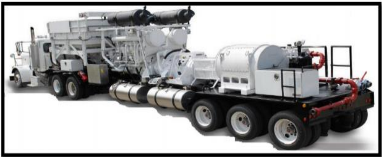
Figura 18.- Unidad de bombeo a alta presión y alto gasto.
