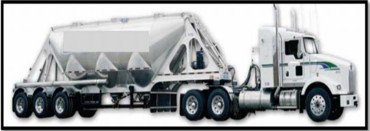
Figura 17.- Tráiler de transporte de apuntalante.
