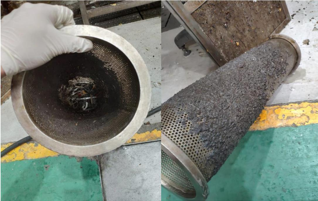
Figura 4.1 Saturación de cedazo cilíndrico.
