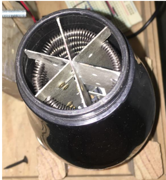
Figura 3.10 Interior del sistema de calentamiento. En esta Figura se puede observar la resistencia de calentamiento, acoplada a un ventilador de difusión de aire de calentamiento.
