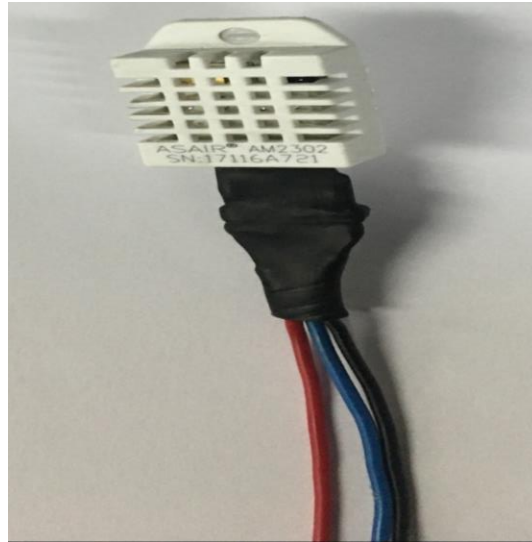
Figura 3.14 Sensor de temperatura DHT22 cableado para su conexión.
