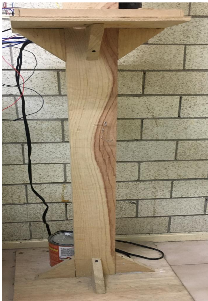
Figura 3.6 Parte inferior del cuerpo mecánico del calorímetro. El mástil de madera, se encuentra fijo a una base del mismo material para permitir su movilidad y posterior manipulación.
