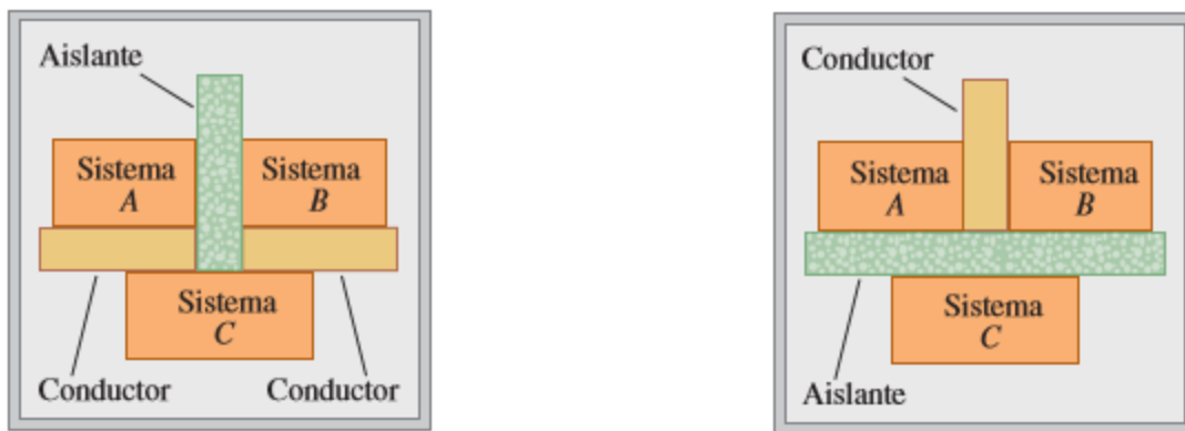
Figura 1.20. La imagen de la izquierda muestra que el sistema A está en equilibrio con el sistema C, pero los sistemas A y B están aislados. También se observa que el sistema C está en equilibrio con B, pero concluyendo que A y B están equilibrio térmico. En la imagen de lado derecho, la pared adiabática se colocó de manera horizontal, por lo tanto A y B están en equilibrio térmico pero no con C, cumpliendo la ley cero para los sistemas en contacto conductor 52 . Tomada de Entropy Demystified The second law reduced to plain common sense. Entropy Demystified (World Scientific, 2016).
