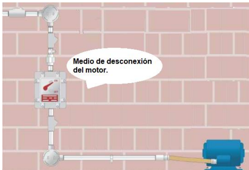
Figura 2.35 Medio de desconexión del motor en un área clasificada. En Understanding the NEC vol. 2 (p.33) Mike Holt's 2014
