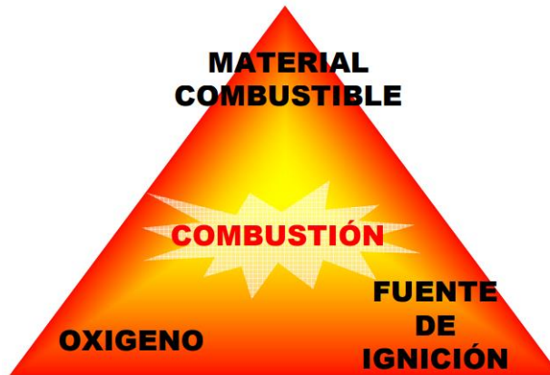
Figura 1.8 Triángulo de los principales elementos para producir un incendio. En clasificación de áreas peligrosas según el National Electric Code (NEC), cortesía de Crouse-Hinds
