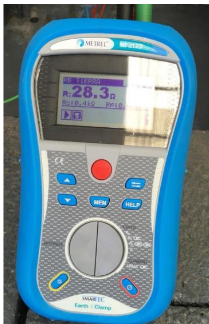
Figura 4.6 Medición realizada en campo con un telurómetro de la marca METREL modelo MI3123
