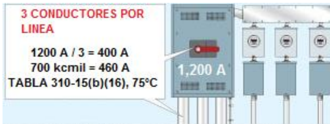
Figura 2.13 Dispositivo de protección mayor a 800 A. En Understanding the NEC (p.190) Mike Holt's 2014
