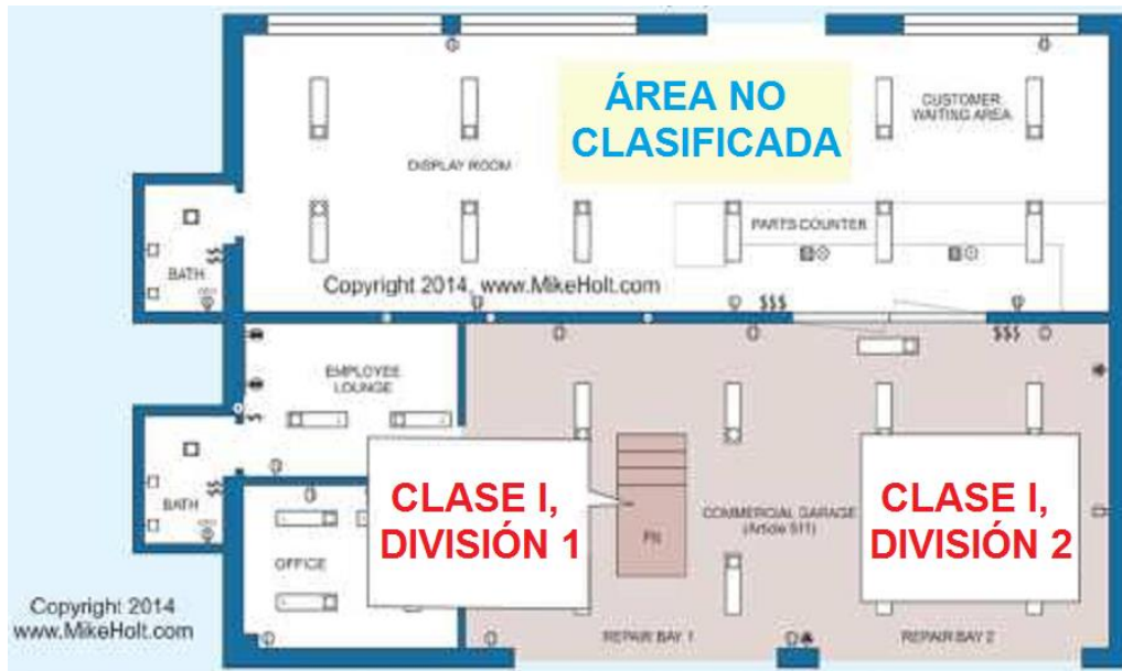
Figura 2.36 Ejemplo de clasificación de áreas peligrosas. En Understanding the NEC vol. 2 (p.26) Mike Holt's 2014
