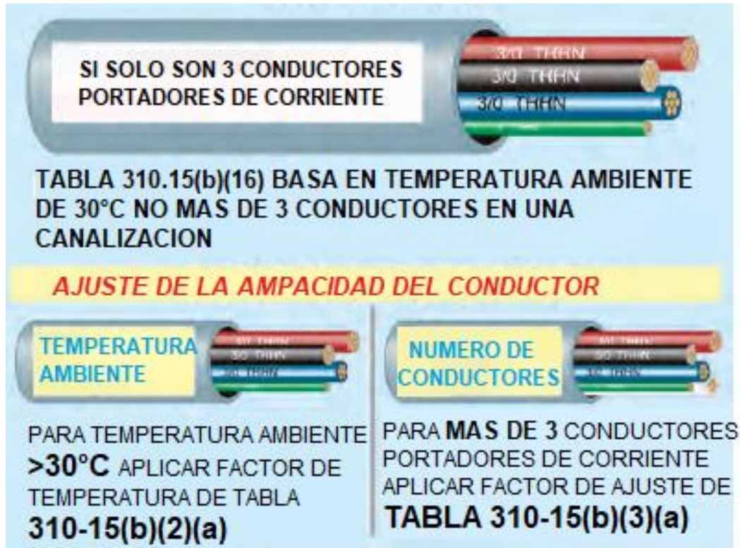
Figura 2.24 Ampacidad de conductores, factor de ajuste y temperatura. En Understanding the NEC (p.340) Mike Holt's 2014
