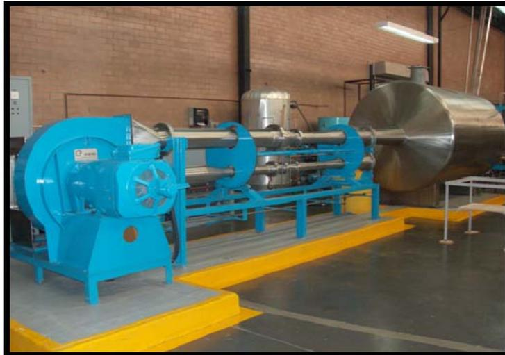
Figura 1.14a. Tubos Venturi para el suministro de aire.
