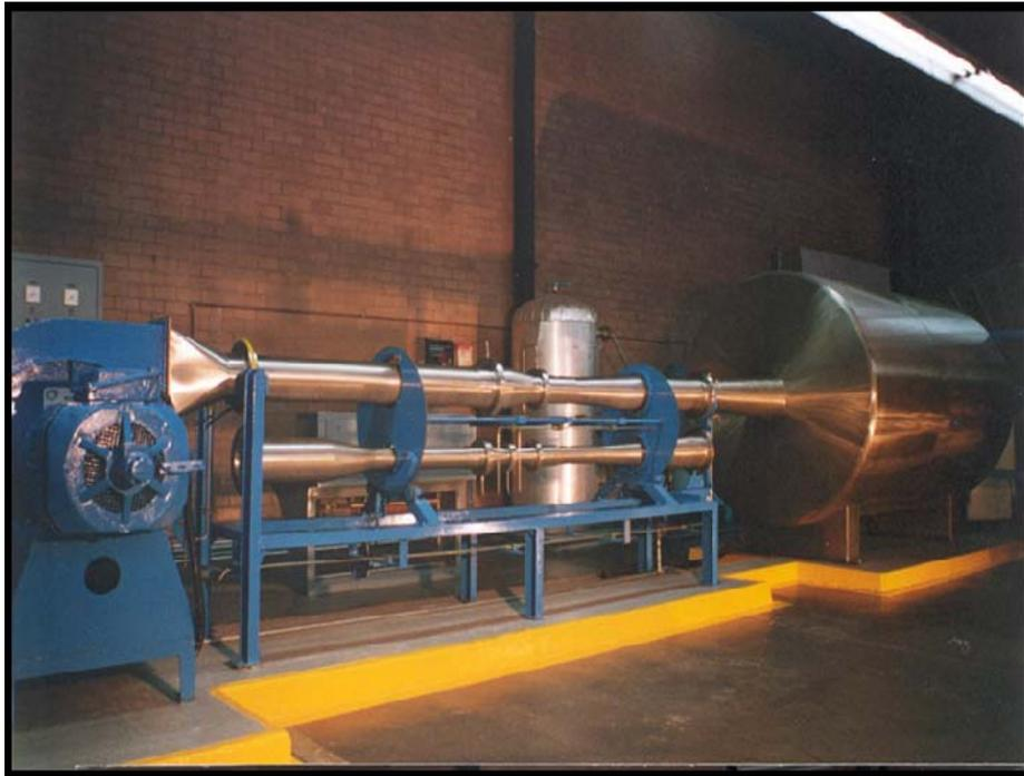
Figura 1.7. Banco de pruebas térmica para radiadores automotrices.
