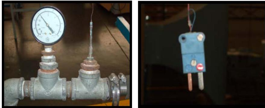
Figura 1.15. Manómetro Bourdon y sensor de temperatura.
