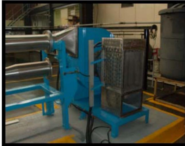
Figura 1.9. Ventilador y banco de resistencias.
