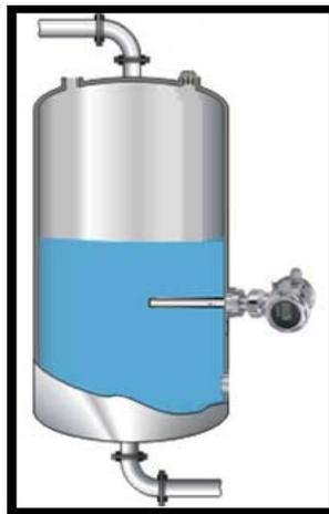
Figura 3.7. Instalación del transmisor de temperature en la Caldera.
