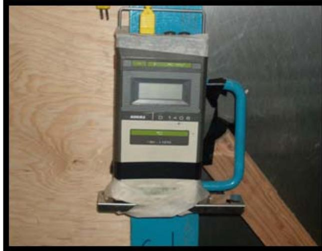
Figura 1.16. Medidor digital de la temperatura del aire.
