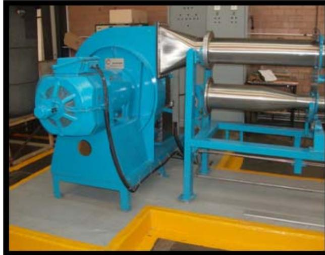
Figura 1.8. Motor Eléctrico y ventilador acoplados.
