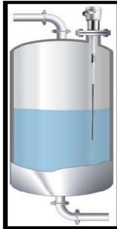
Figura 3.6. Instalación del transmisor de nivel en la Caldera.
