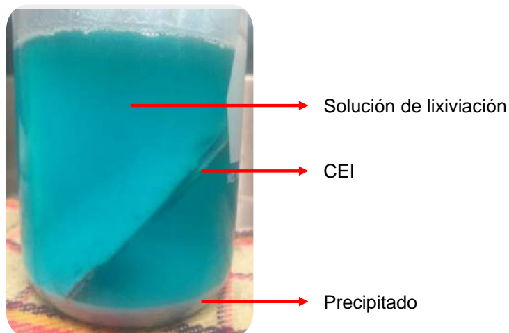
Figura 10. Lixiviación de CEI con una solución de \text{HNO}_3 - 3 N a temperatura ambiente.
