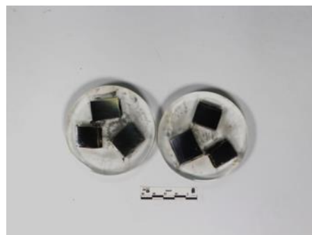
Figura 18. a) Montadora Mecapress 3. b) probetas montadas en mecapress 3 con lucita
