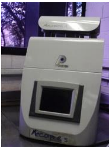
Figura 18. a) Montadora Mecapress 3. b) probetas montadas en mecapress 3 con lucita
