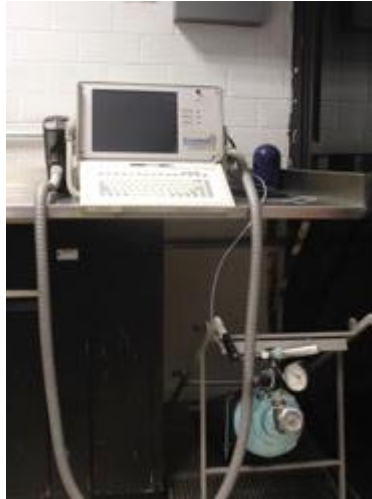
Figura 16. Belec Compact Port, equipo para análisis químico.
