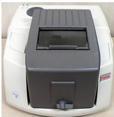
**Figura 2.2.** Equipo utilizado para la caracterización por FT-IR de los bpolímeros acrílicos
