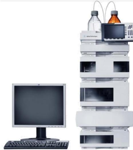
**Figura 2.6.** Equipo utilizado para el análisis SARA por HPLC
