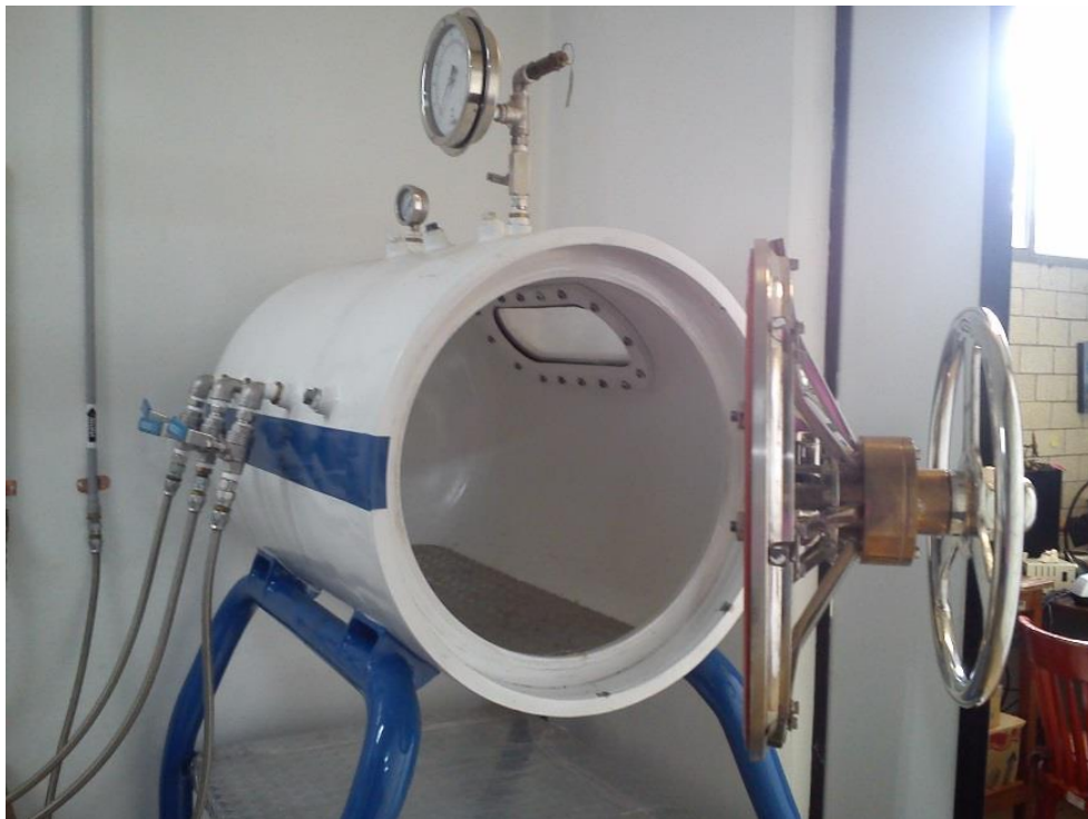
Fig. 11 Cámara hiperbárica experimental
