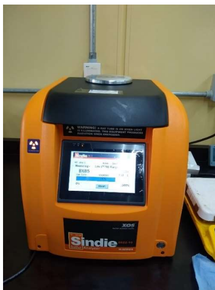
Figura 2.1. Analizador de azufre XOS Sindie 7039
