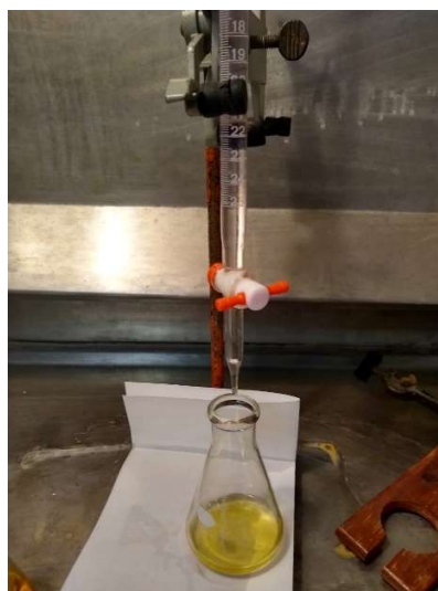
Figura 2.3. Titulación de la mezcla ACR-éter/etanol
