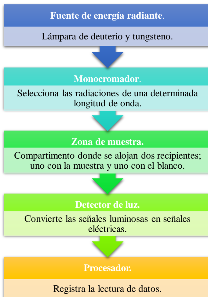
Figura 7. Componentes del espectrofotómetro UV – VIS.
