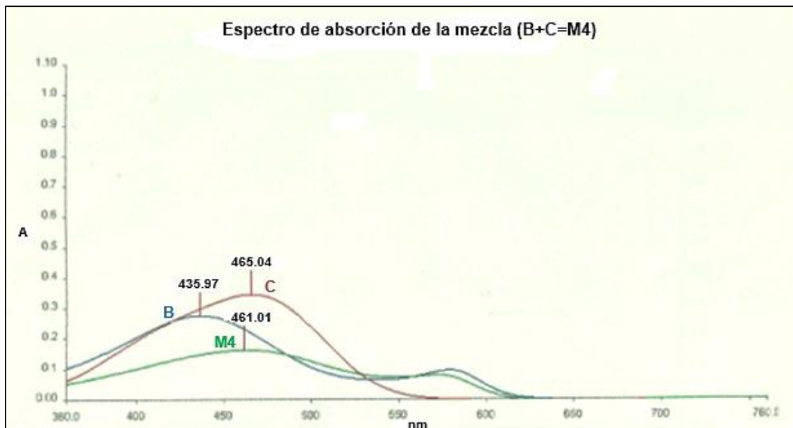
Figura 41. Espectro de absorción de la mezcla M4: Naranja de xilenol (B) y naranja de metilo (C) en agua destilada.
