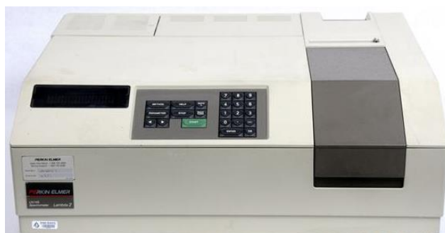
Figura 20. Espectrofotómetro UV – VIS Lambda 2S. [Artisan Technology Group, S. F.]
