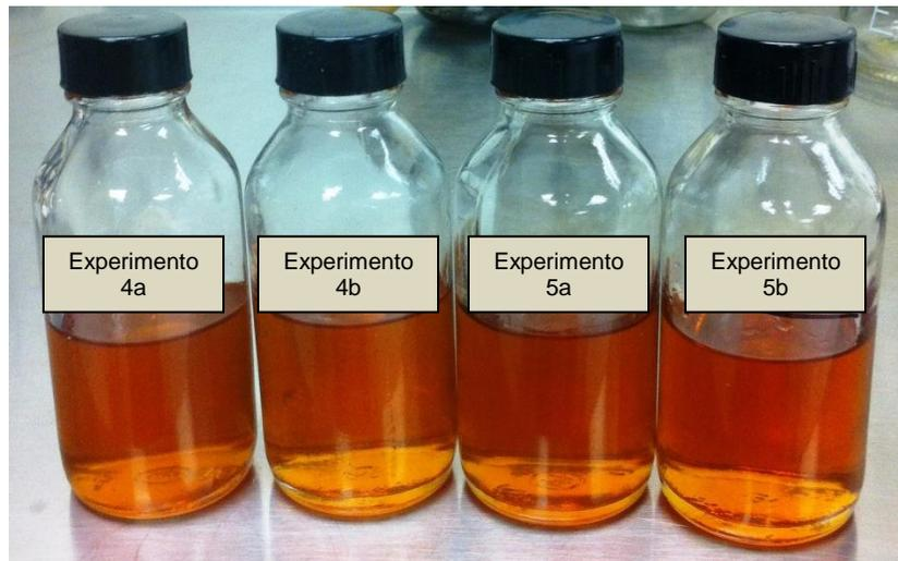
**Figura 3.5** De izquierda a derecha, licores de lixiviación ácida 4a, 4b, 5a y 5b.
