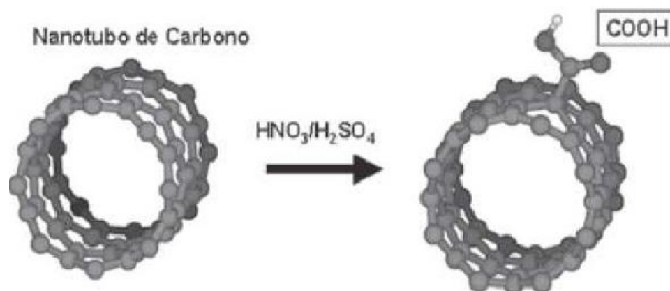
Figura 1.3. Representación esquemática de la funcionalización agregando grupos carboxilo (COOH) a la superficie del NTC.
