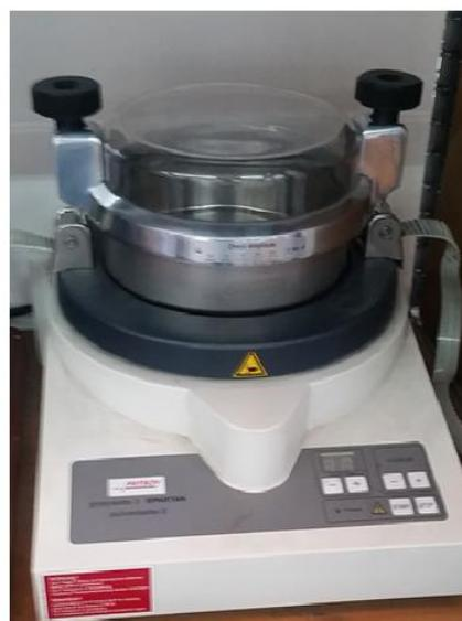
**Figura 22 Molino horizontal Heiko (izquierda) y molino vibratorio Spartan (derecha).**
