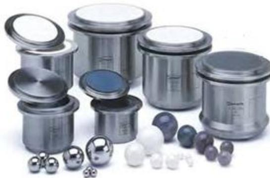
**Figura 17 Recipientes y medios de molienda usados en AM.**
