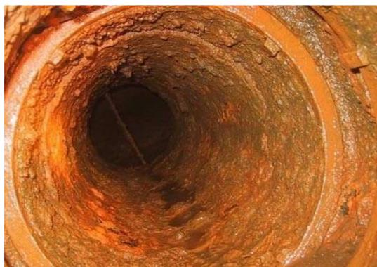
**Figura 7 Corrosión generada por la presencia de azufre en un ducto de distribución de crudo.**
