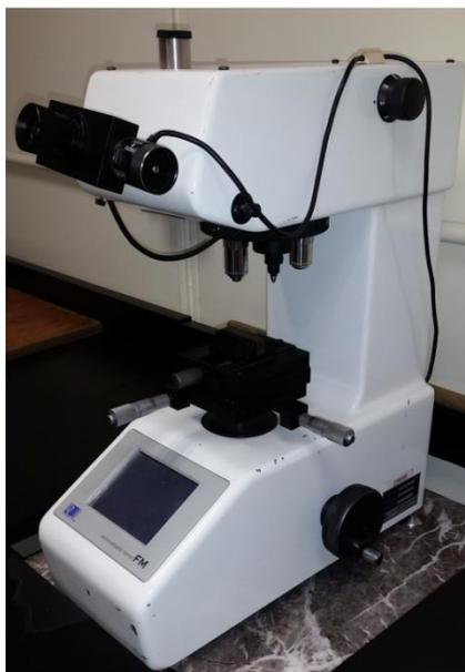
**Figura 23** Equipo microhardness tester FM de la marca Future-Tech.
