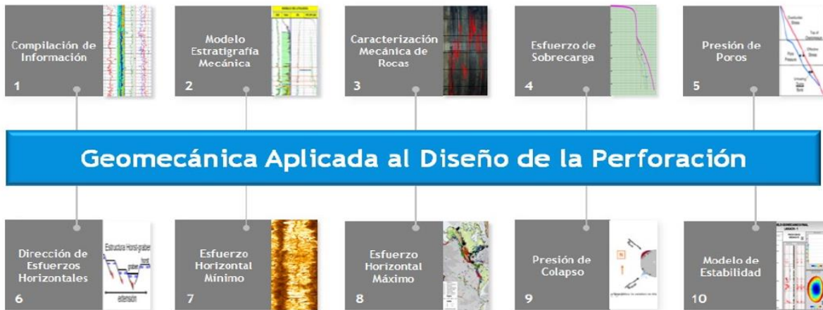
Figura 5. Diagrama de flujo de geomecánica aplicada al diseño de la perforación
