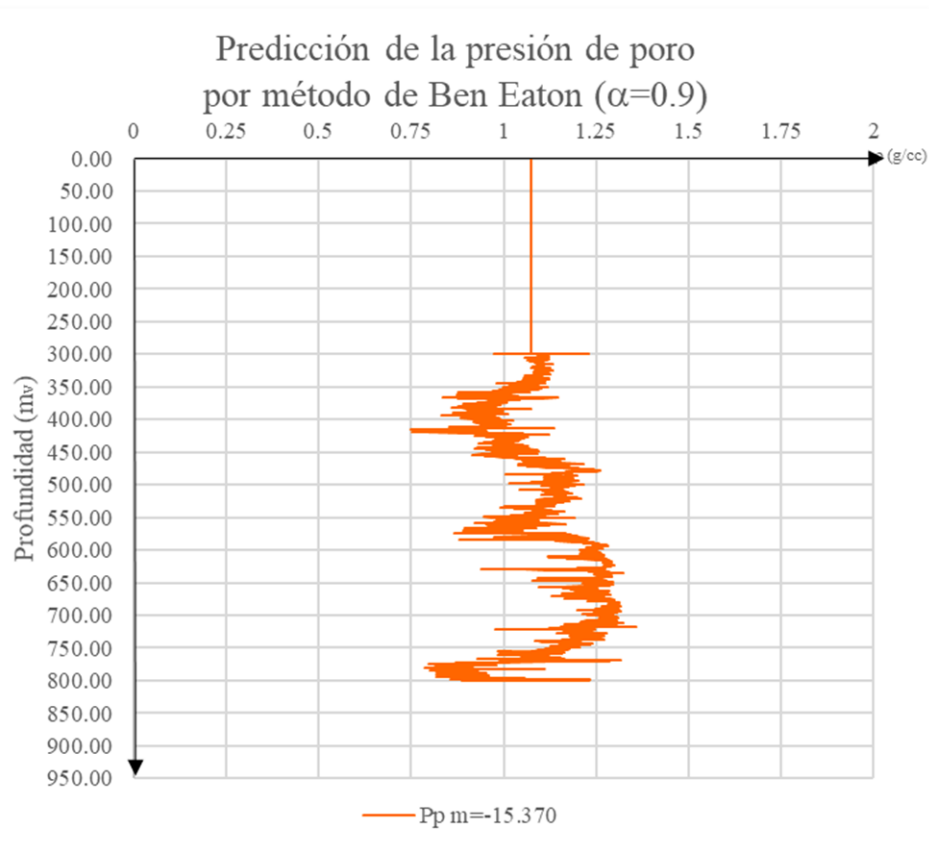
Figura 41. Curva de la predicción de la presión de poro correspondiente a la línea de TCN seleccionada, por el método de Ben Eaton sónico y exponente \alpha=0.9 .
