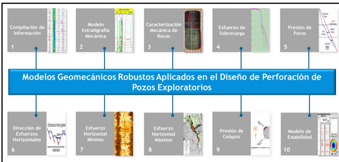
Figura 6. Diagrama de flujo de modelos geomecánicos robustos aplicados en el diseño de la perforación de pozos exploratorios.
