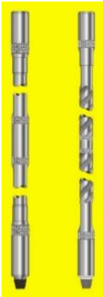
Figura 23. Tubería de transición.
