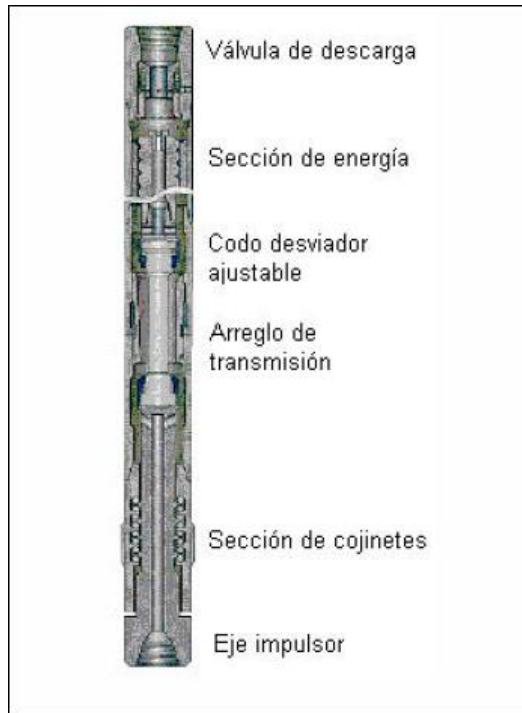
Figura 20. Motor de fondo con sus componentes.
