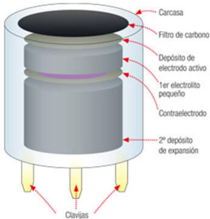
**Figura 3.1:** Esquema de sensor electroquímico.
