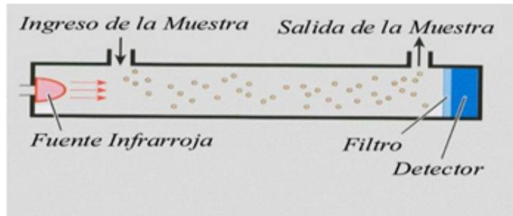
Figura 3.3: Esquema de un sensor Infrarrojo.
