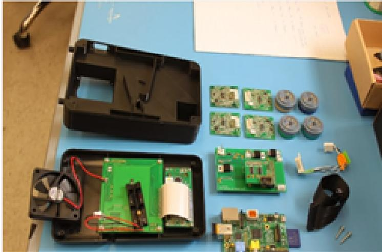
**Figura 2.5:** Componentes utilizados en los equipos "node" del proyecto CLAIRITY.
