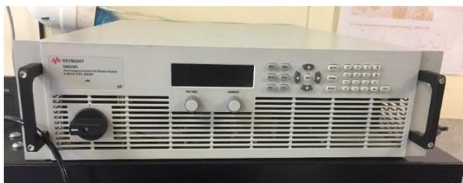
Figura 2.4. Fuente de potencia a DC
