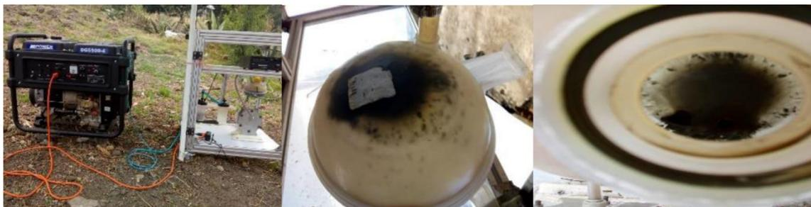
*Figura 1.21 Motor de prueba y separador de fases después de 200 h de operación.*
