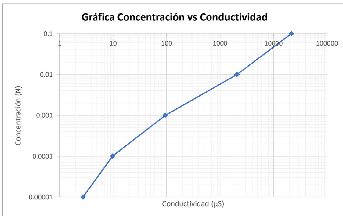
*Figura 3.1 Gráfica de Concentración contra Conductividad a diferentes concentraciones*
