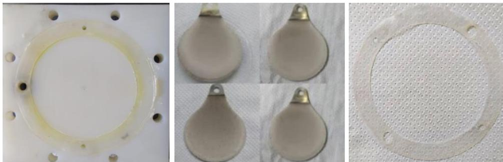
Figura 2.3. Componentes del electrolizador de prueba
